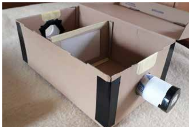
Slika 5: Kamera obskura in model fotoaparata v eni škatli – fotografija.
