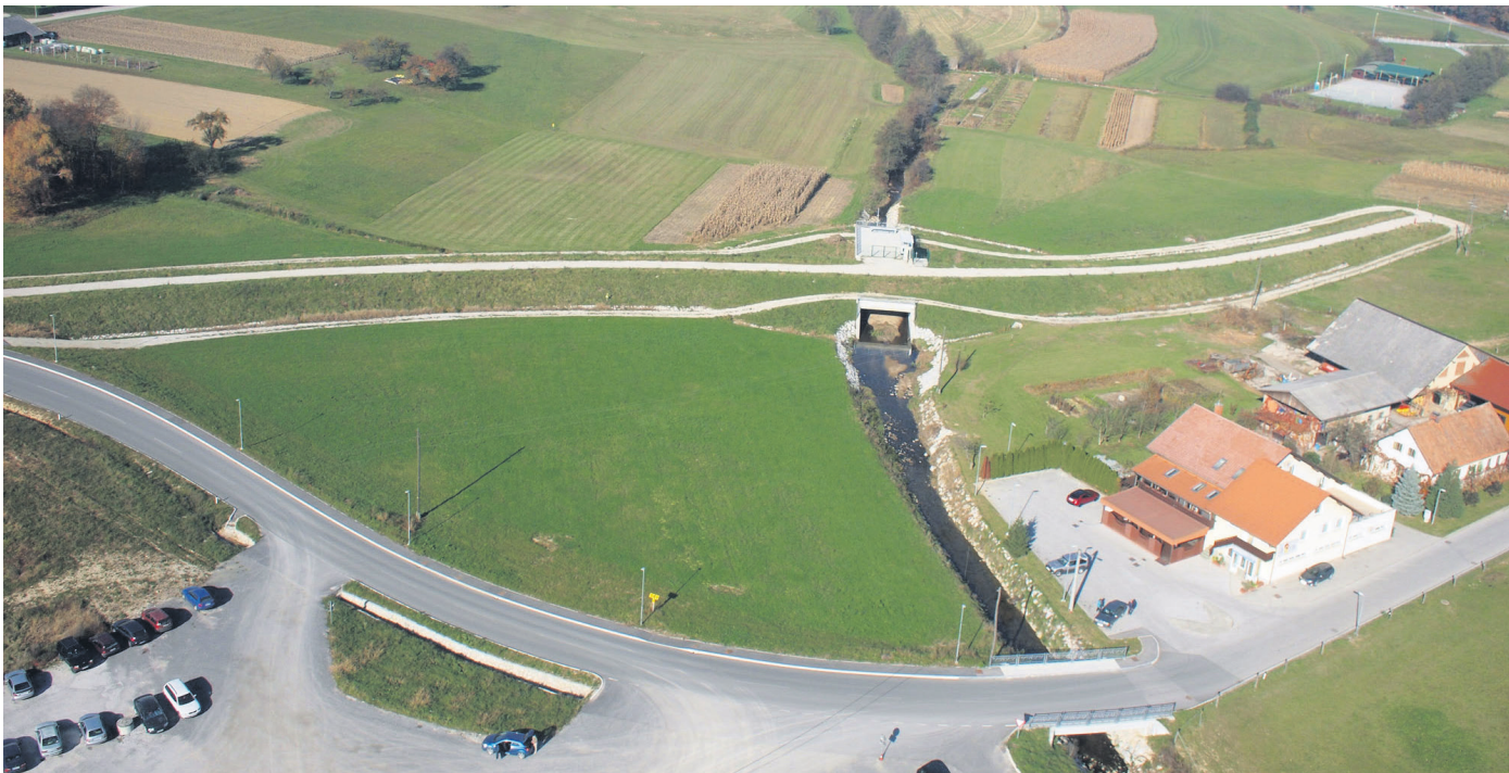
Primer suhega zadrževalnika na Podsevnici na Lopati. Gre za območje, po katerem se razlije visoka voda v času poplav. (Foto: Nivo Eko)
