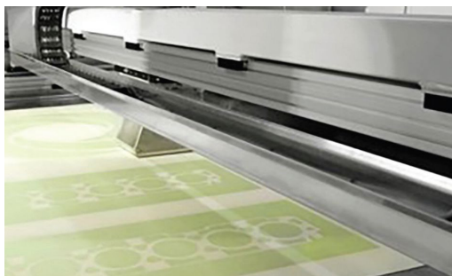
Slika 6. Delovna komora z natisnjenimi jedri utrjenimi s furfuril alkoholom in neutrjenim peskom prevlečenim z aktivatorjem
