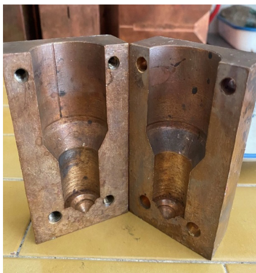
Slika 1. Bakrena kokila, uporabljena v procesu ulivanja.
