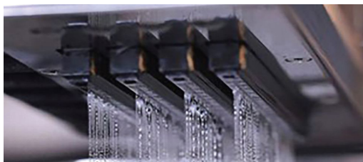
Slika 5. Tiskalna glava brizga vezivo na osnovi furfuril alkohola
