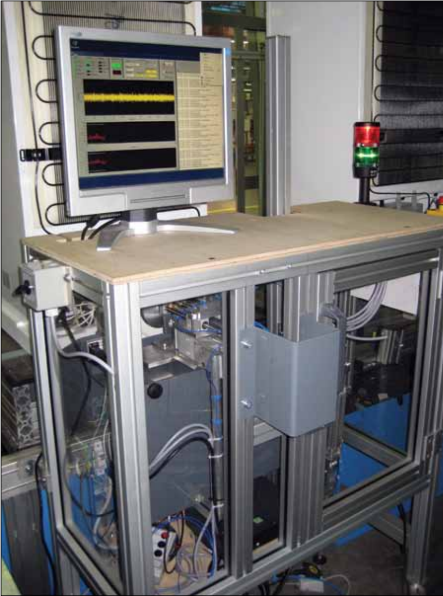
Slika 1. Mehatrični sistem za zaznavanje kakovosti kompresorjev hladilnih aparatov
