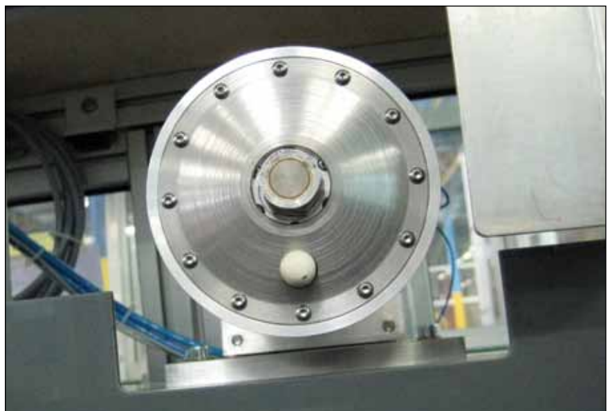
Slika 2. Senzorska glava z membransko vpetim senzorjem vibracij
