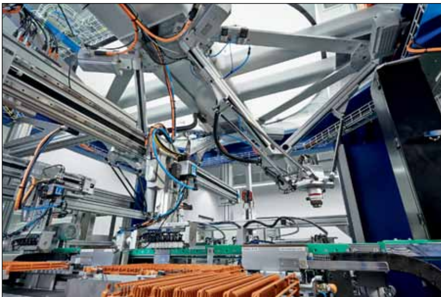
Slika 6. S taktom 120 sestavnih delov na minuto dva tripodna?? (deltoidna) robota EXPT jemljeja s tekočega traku dele in jih odlagata na pladenj za elektronske sestavine (foto: Festo AG &Co. KG).
