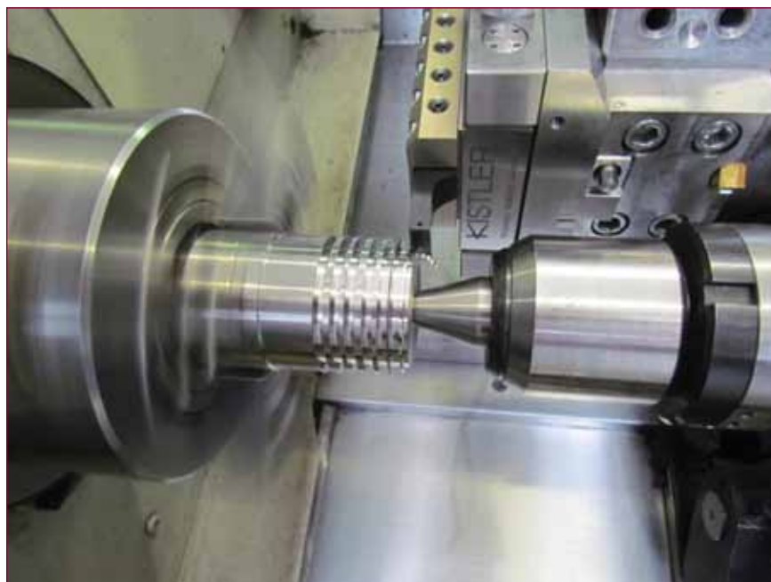
Slika 4. Ortogonalno (suho) odrezavanje
