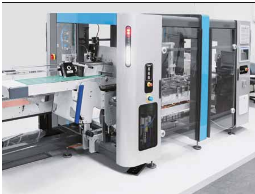
Slika 5. Odličen primer stroja za pakiranje iz »prebojne generacije« podjetja Cama z zmanjšano tlorisno površino. V treh korakih stroj kartone odpre, napolni s različnimi izdelki in jih zapre (foto: Festo AG &Co. KG).
