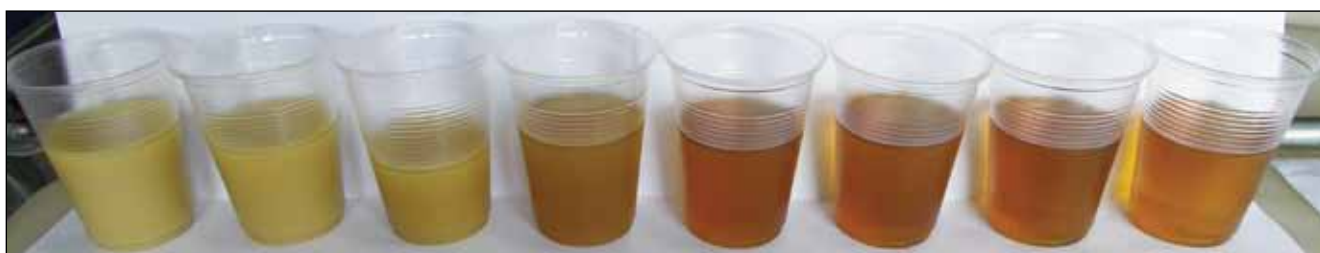
Slika 8. Spreminjanje videza olja glede na vsebnost vode v njem
