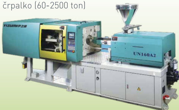
Seriya A2 - opremljena z variabilno črpalko (60-2500 ton)
