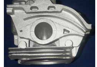
dokončno obdelan ulitek brez vidnih sledi varjenja
