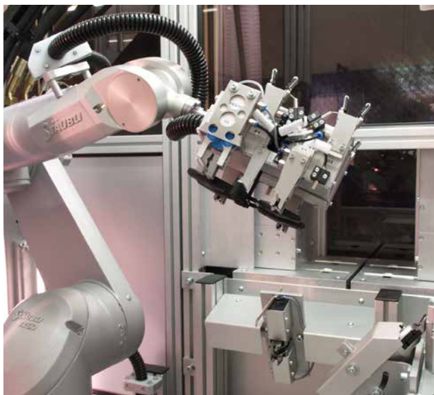
► V popolnoma avtomatizirani standardni celici za brizganje manjših izdelkov iz plastike robot Stäubli TX60 streže stroju in mehansko obdelava izdelek.
