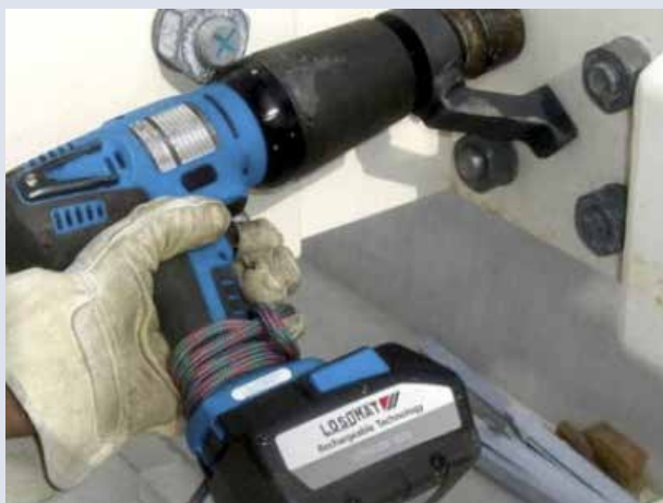
► Baterijski multiplikator navora Loesomat LDA z zateznim navorom 4800 Nm
