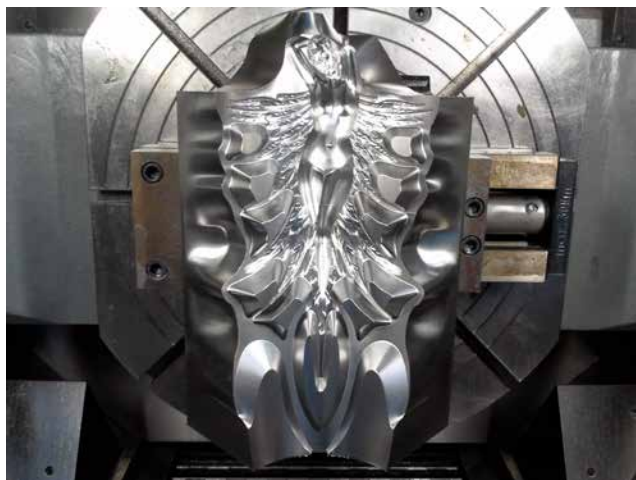
» Kalup iz posebne železove litine za ekskluzivno skulpturo iz kristalnega stekla
