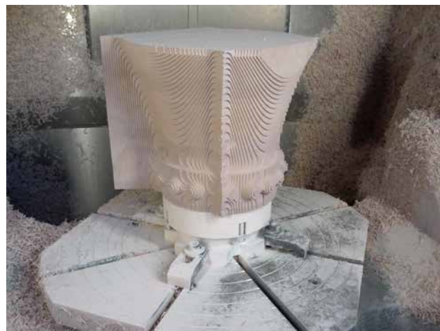
» Delovno območje obdelovalnega centra C 30 U z NC-vrtljivo nagibno mizo premera 630 mm za kompletno petosno obdelavo zahtevnih prototipov, kalupov, modelov in orodnih segmentov v treh dimenzijah
