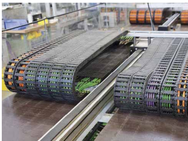
» Podjetje igus zanesljivost kablov Chainflex M zagotavlja s stalnim preskušanjem v lastnem 1750 m 2 velikem laboratoriju. Dve milijardi testnih ciklov, vsako leto na 180 testnih postajah.
