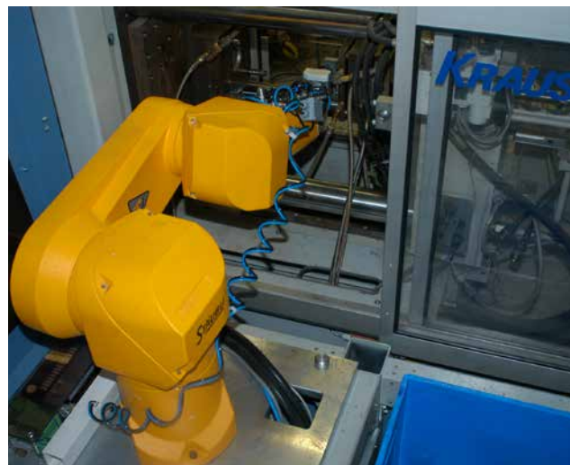
► Kompaktni šestosni robot Stäubli že vrsto let brezhibno opravlja svojo nalogo v podjetju Bürkert Fluid Control Systems. V avtomatizirani celici stroj za brizganje izdelava plastične sestavne dele pogona, robot pa jih samodejno sestavi.
