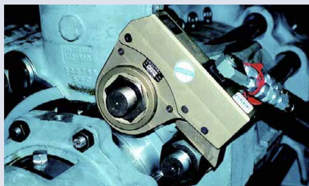
› Hidravlični momentni ključ Loesomat LDK obvlada navore med 160 in 24000 Nm.
