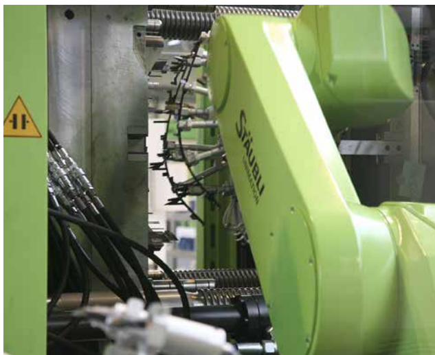
► Dobavitelj avtomobilske industrije Key Plastics uporablja Englovo celico za brizganje plastike z robotom Stäubli. Z odprtim vmesnikom je programiranje šestosnega robota popolnoma integrirano v Englov krmilni proizvodni sistem. (Foto: Engel)
