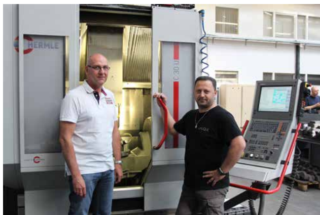
» Vodja orodjarne Christian Vollmer in programer stroja Coskun Yesiltas pred petosnim visokozmogljivim obdelovalnim centrom C 30 U, opremljenim s krmiljem Heidenhain iTNC 530, ki je idealno za orodjarstvo
