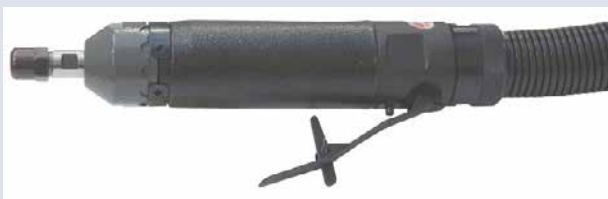
› Yokota RRI-3425 je premi brusilnik z dodatno cevjo za dušenje hrupa odvečnega zraka (njegova glasnost znaša vsega 80,2 db (A)).
