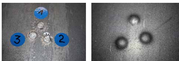
» Oblika in velikost interakcije izstrelka na sprednji (levo) in zadnji strani tarče (desno) iz jeklene pločevine PROTAC 500
