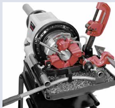
► Naprava za vrezovanje navojev z enofaznim asinhronskim motorjem Roller Robot ½"-3"
