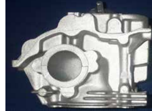
dokončno obdelan ulitek brez vidnih sledi varjenja
