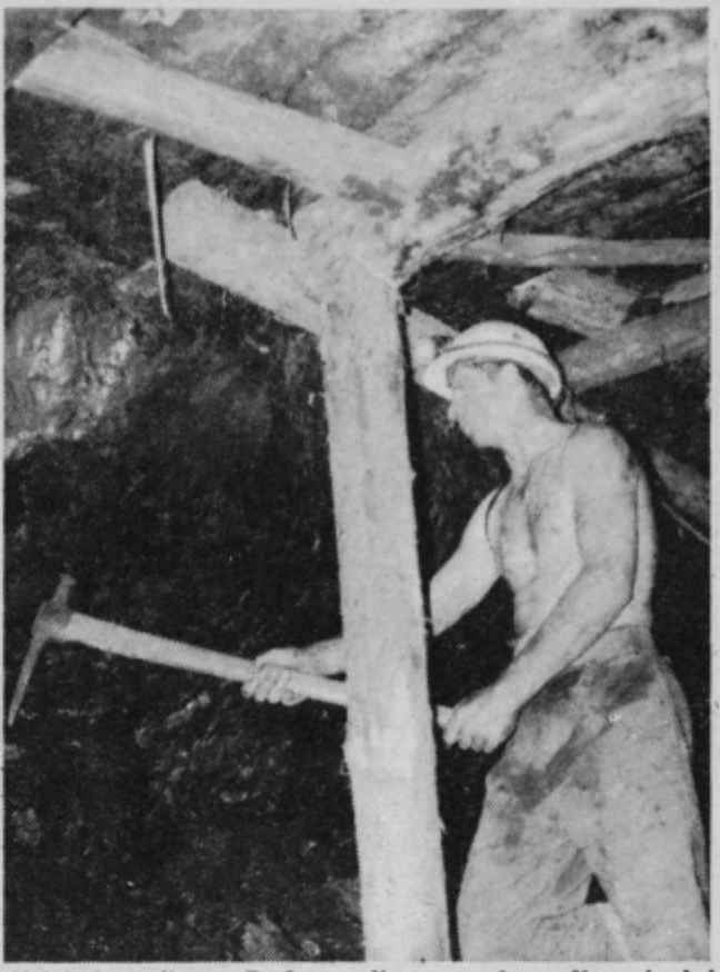
V debelem »flecu«. Rudar v odkopnem oknu odkopuje sloj kvalitetnega rjavega premoga. Opaž, ki varuje delavce pred vdori je lesen.
