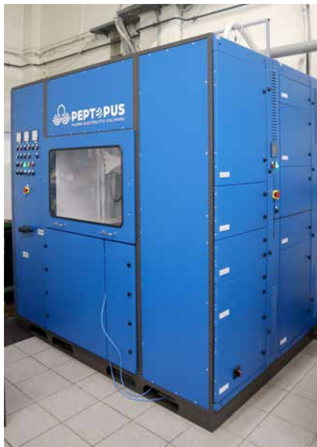
Slika 1 : Naprava za plazemsko elektrolitsko poliranje (Foto: Arhiv FS)
