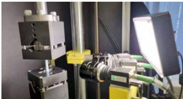
Slika 2 : DIC-sistem za merjenje deformacijskih polj (Foto: IFP, d. o. o.)
