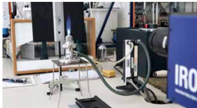
Slika 3 : Optični sistem za spremljanje emisije reaktivnih tokov v IR- in UV-spektru (Foto: Arhiv FS)
