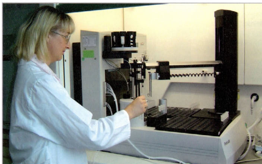
Aparatura za pripravo vzorcev Prelude Workstation Zymark. Vzorce za analize pripravljajo z dodajanjem, razredčevanjem, mešanjem, odvzemanjem ali filtriranjem raztopin.
