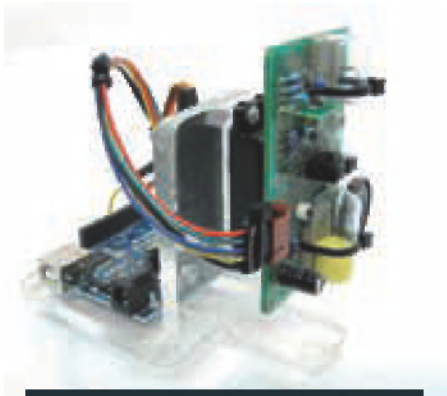
RNG domače izdelave, ki z optičnim tipalom meri padanje zrn peska skozi grlo peščene ure. Ko pesek izteče, elektromotorček uro obrne.
