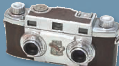
Stereoskopski fotoaparat Revere uporablja klasični 35 mm film, a zajema manjše negative, ki se ne skladajo z odprtini na pladnjih optičnih bralnikov.
