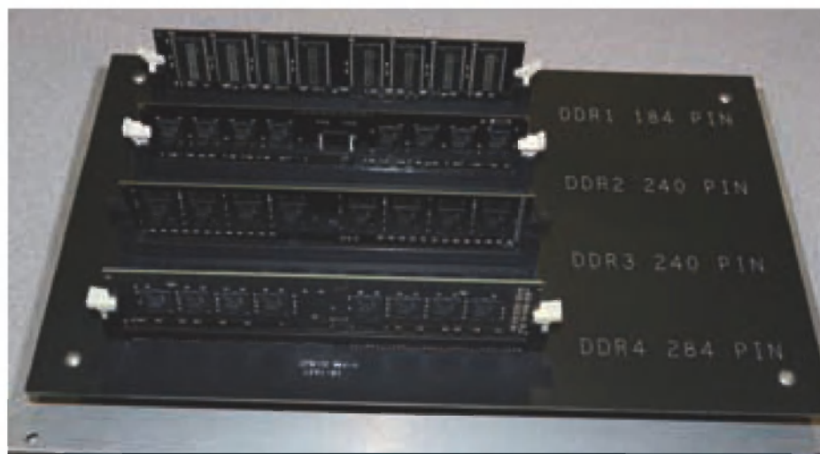
Primerjava pomnilniških modulov SDRAM DIMM vrst DDR1, DDR2, DDR3 in DDR4
