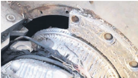
Poškodovan rezalni rotor na mlinu za mletje. Velik kos železa je povzročil lom rotorja in celotne sejalne enote, škode je bilo za več kot deset tisoče evrov (na fotografijah 3 in 4).
