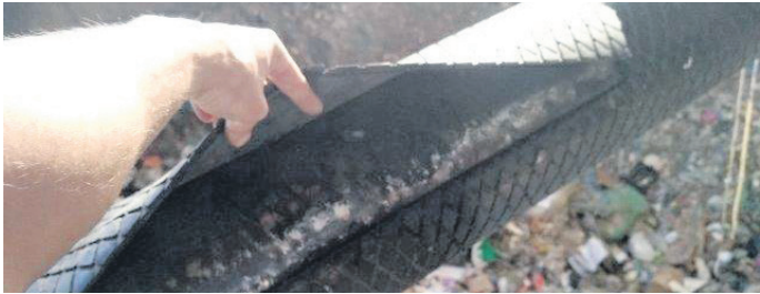
Poškodovan pogonski valj transportnega traku. Velik kos armiranega betona je povzročil poškodbo – lom konstrukcije traku – poškodbo transportne gume in pogonskega valja.
