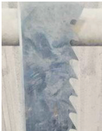
Poškodovana transportna guma. Kovinski tujek – žagin list – se je zapilčil v rob transportne gume in jo prečno prerezal.
