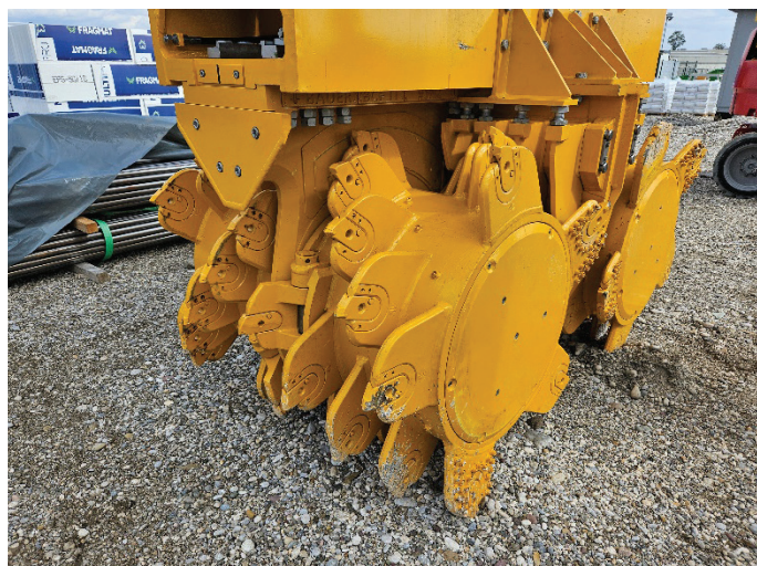
Slika 4. Rezkalni obroči hidrofreze.
