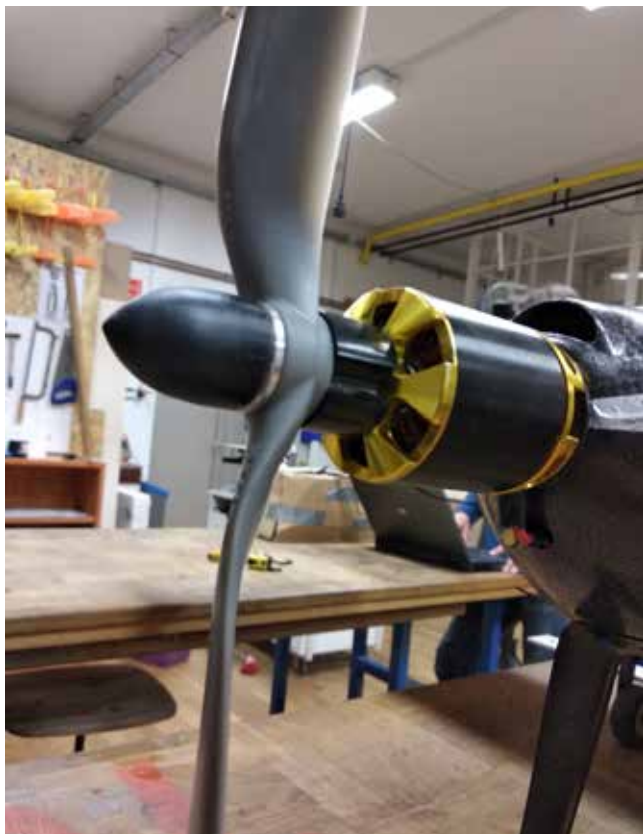
Skoraj 3-kilowatni Scorpionov pogonski motor je zagotavljal 7 kg statičnega potiska
