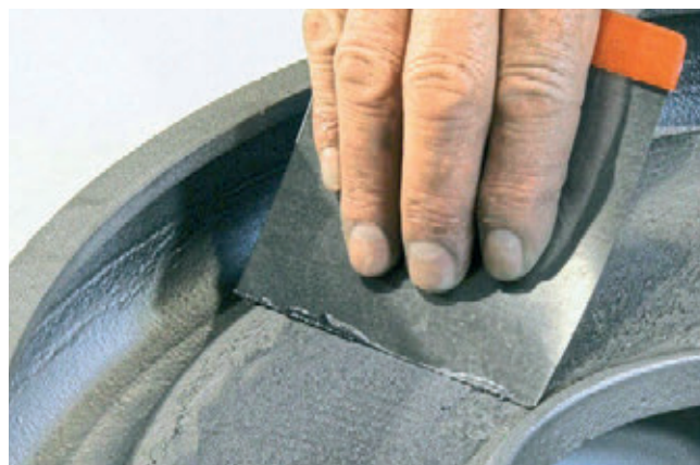
» Dvokomponentna reakcijska masa na osnovi smole Ultrametal se lahko uporablja pri popravilu kovinskih izdelkov iz aluminija, bronu, jekla in železa. (Vir: Diamant Metallplastic)
