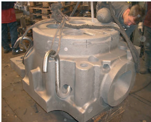
» Glava cilindra velikega dizelskega: ulitek iz litega železa tehta več kot tona. (Vir: Voxeljet)
