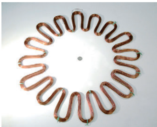
» Eno izmed treh navitij, ki se vgradi v elektromotor velikega premera z režo v aksialni smeri. Vir: MachineDesign
