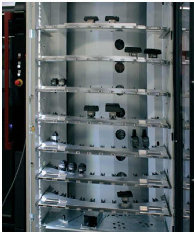
» Zalogovnik lahko vsebuje do 120 grafitnih elektrod.
