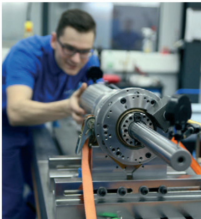
» Med vzdrževanjem vretena v podjetju Okuma zamenjajo vse pomembne dele, vključno z rotacijskim dovodom za hladilno mazalno tekočino. Vir: Okuma
