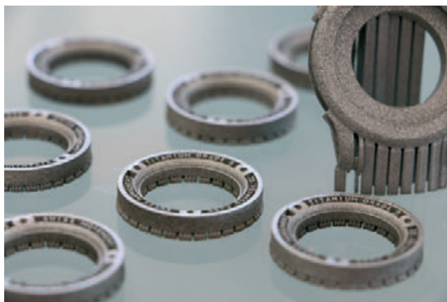
» Ohišje ure 'Ornament 1', natisnjeno iz titana na sistemu Renishaw AM 400
