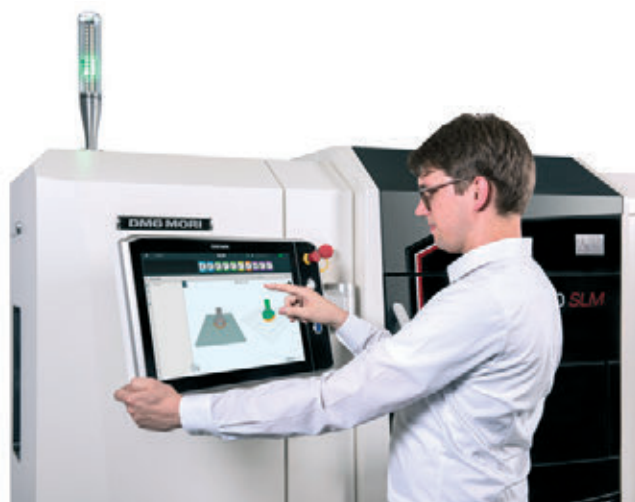
» Programska oprema RDesigner, razvita v podjetju DMG MORI, omogoča učinkovito CAM-programiranje neposredno na samem obdelovalnem stroju. Vir: DMG MORI
