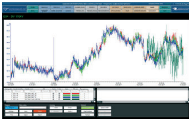
» Poročanje v programski opremi zenon: kombiniran diagram toka in napetosti transformatorske postaje Šipovo.
