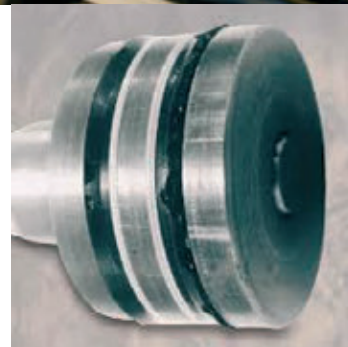
» Slika 5: Poškodba tesnil zaradi pojava »dizel efekta« znotraj HV
