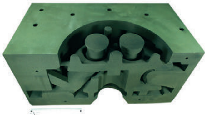
» Peščena forma za glavo cilindra velikega dizelskega motorja proizvajalca MAN izdelana s 3D-tiskalnikom: forma velikosti 1.460 x 1.483 x 719 mm je bila izdelana v 29 urah z uporabo 3D-tiskalnika za livarski pesek (Vir: Voxelfjet)
