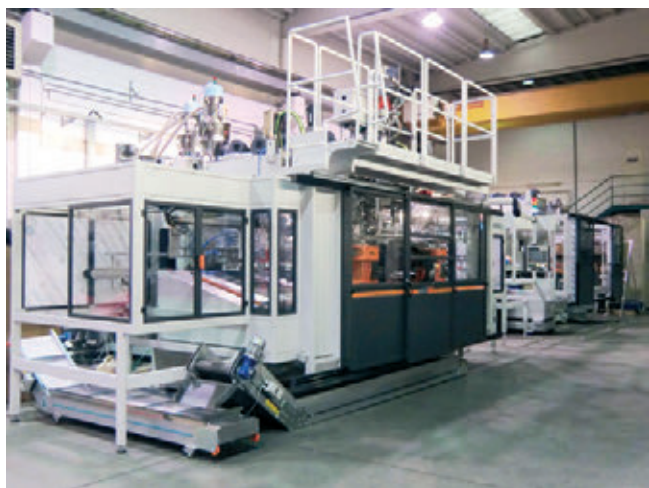
» Plastiblow – električni stroj za pihanje, z dvema postajama, orodje z dvema gnezdoma, model PB10E/DXL, koekstrudira dve plasti, za izdelavo 5-litrskih posod Castrol GTX z dvema ročajema, s prozornim pasom
