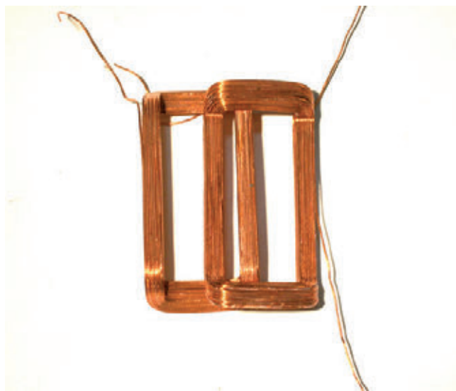
» Konci prepletenih zank tuljave so oblikovani tako, da so odseki med magneti v eni ravnini, kar zmanjša režo med magneti in posledično poveča navor elektromotorja. Vir: MachineDesign
