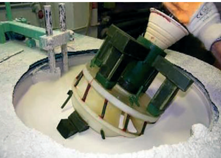
» Natisnjen model pri nanašanju keramične lupine za precizijsko litje. Pred litjem se model izžge iz keramične lupine, ki se uporabi kot kalup pri litju. (Vir: Voxeljet)
