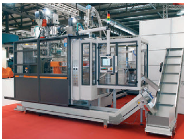
» Plastiblow – električni pihalni stroj, model PB10E/SXL, z eno postajo, za proizvodnjo 5-litrskih posod z orodjem s tremi gnezdi
