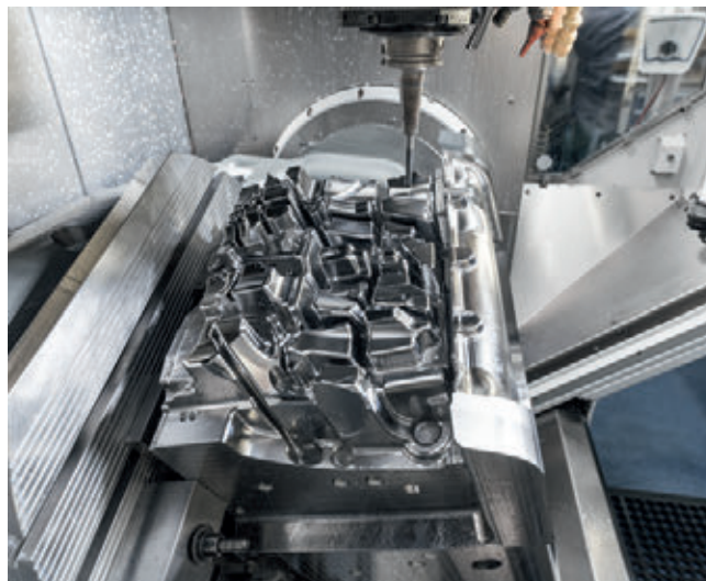
» Zaključna faza obdelave gravure za orodje velikih dimenzij na 5-osnem obdelovalnem centru v podjetju HETEC GmbH. Vir: HETEC GmbH
