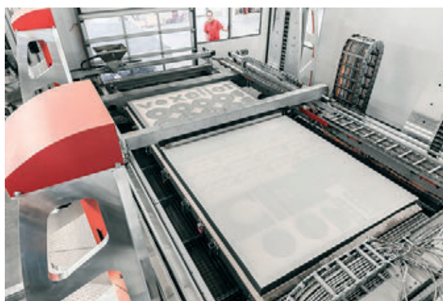
» 3D-tiskalnik proizvajalca Voxeljet VX 4000 z delovnim volumnom 8 m 3 (4 x 2 x 1 m). (Vir: Claus Brechenmacher & Reiner Baumann)
