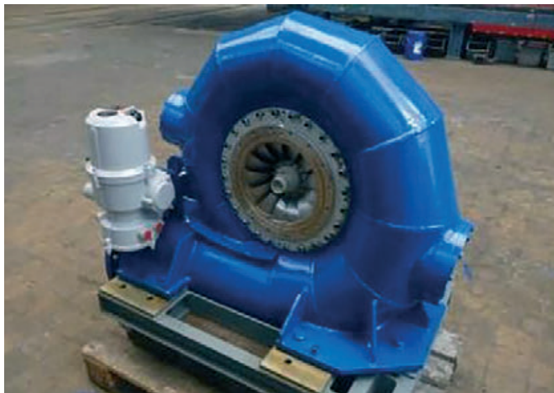
» Končen izdelek: vgrajen rotor izdelan s postopkom precizijskega litja, za katerega se je uporabil model narejen s 3D-tiskanjem. (Vir: Voxeljet)
