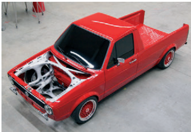
» Sprednja struktura vgrajena v vozilo: z integracijo različnih funkcij v strukturo se zmanjša masa in pridobi prostor pod pokrovom motorja. (Vir: CSI)
