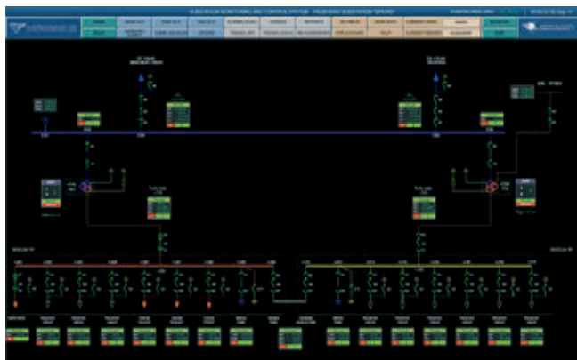
» Set enopolnih elektro shem s statusi, meritvami, opcijami nadzora in funkcijo avtomatskega barvanja vodov.
