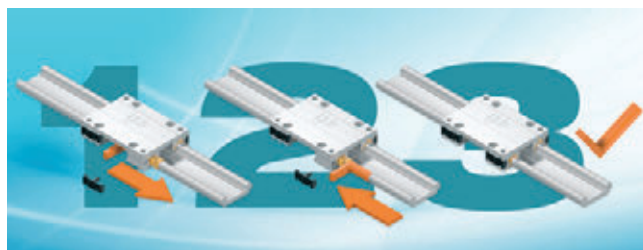
» Menjava ležaja v nekaj sekundah: sprostite ležaj, drsni vložek z montažnim orodjem potisnite ven in novo folijo nazaj v voziček.
