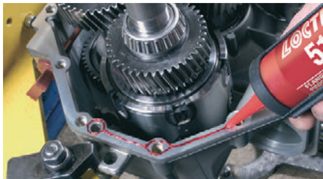
» Anaerobno tesnilo je primerno za toge prirobnice z majhnimi zračnostmi
