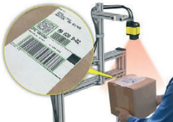
» Čitalec serije DataMan 470 omogoča hkratno branje različnih eno- in dvodimenzionalnih kod ter številnih mešanih simbologij. Vir: Cognex
