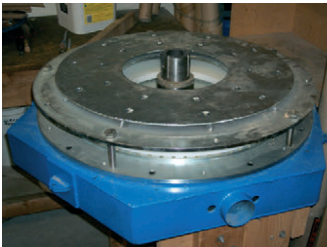
» Brezkrtačni enosmerni elektromotor/alternator z režo v aksialni smeri premera 762 mm proizvajalca Empire Magnetics, namenjen za vgradnjo v vetrno elektrarno. Kot alternator proizvaja trifazni izmenični tok z napetostjo 220 V in močjo 3,3 kW pri 180 obratih na minuto. Vir: MachineDesign
