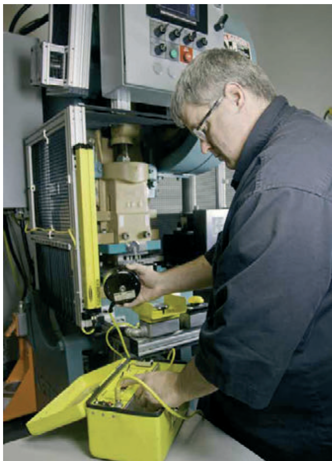
» Meritev časa ustavitve stroja natančno določi, v kolikšnem času od pritiska na tipko stop ali sprožitve varnostnega stikala pride do popolne ustavitve nevarnega delovanja stroja. | Vir: MachineDesign
