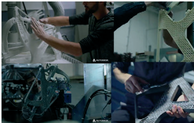
» Okvir stola iz magnezija sestavljen iz štirih komponent izdelanih s postopkom 3D-tiskanja kovin stane približno 12.000 dolarjev. Uporaba 3D-tiskanja plastičnega modela stola, ki se ga uporabi pri precizijem litju, omogoča litje stola v enem kosu, pri čemer strošek izdelave znaša približno 4.000 dolarjev, kar je trikrat manj v primerjavi z neposrednim 3D-tiskanjem. (Vir: Autodesk)
