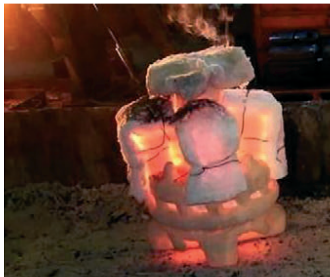
» Pri precizijskem litju se v prazno keramično lupino ulije staljen aluminij in ko se strdi, se keramična lupina odstrani. (Vir: Voxeljet)
