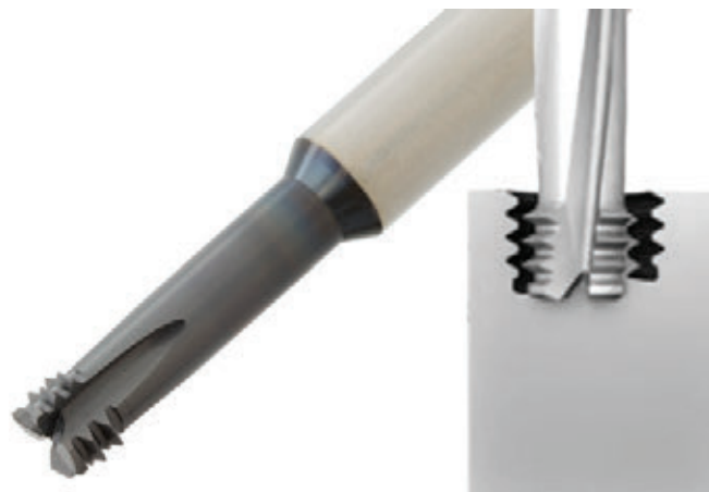
» Navojni rezkar OSG WH-EM-PNC izdelava navoj z rezkanjem v polno brez predhodnega vrtanja. Posebej primerni so za izdelavo navoja v trde materiale.
