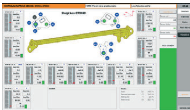
» Slika 13: Zaslonski prikaz, ki prikazuje, da so bile vse meritve znotraj tolerančnega območja.
