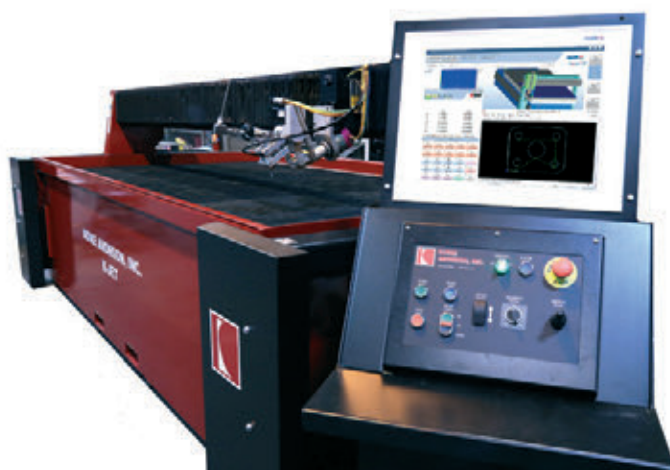
» Podjetje NUM je pomagalo podjetju Koike Aronson pri razvoju izjemno natančne 5-osne rezalne glave za vgradnjo v njihov tržno uspešen stroj za rezanje z abrazivnim vodnim curkom K-Jet. Vir: NUM
