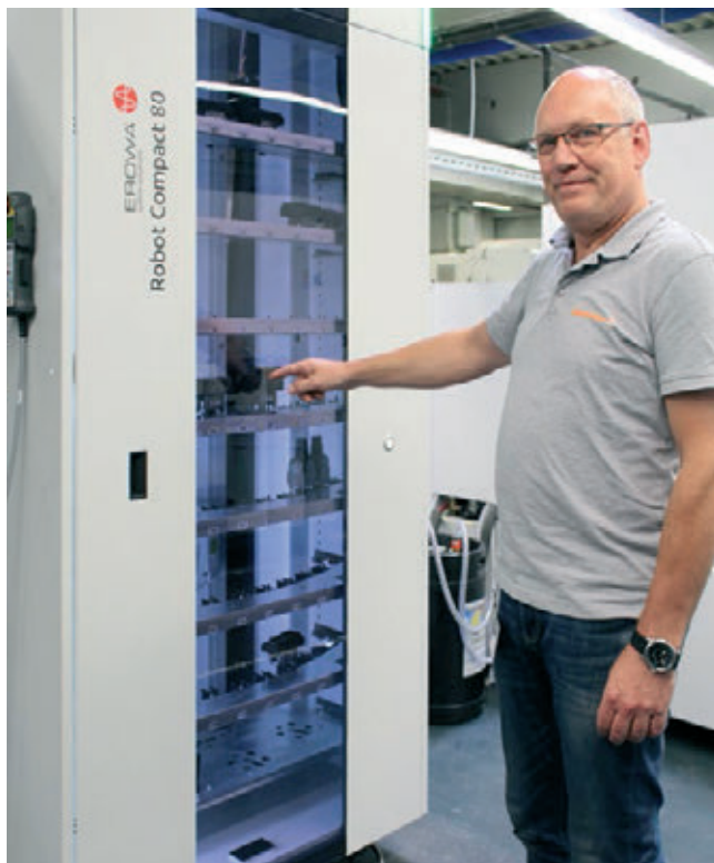
» Ralf Runte, vodja mehanske obdelave orodij pri podjetju Weidmüller, prikazuje kombinacijo robota ERC 80 podjetja EROWA in sistema ATOS ScanBox Series 4 podjetja GOM v avtomatizirani rešitvi za merjenje grafitnih elektrod.
