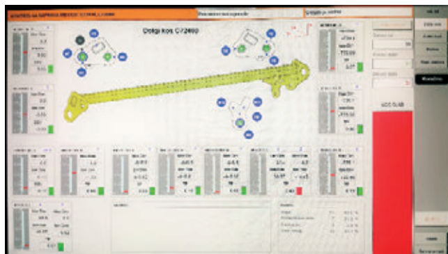
» Slika 14: Zaslonski prikaz, ki prikazuje, da meritve niso bile znotraj tolerančnega območja.
