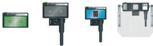
»Slika 2: Od leve proti desni so prikazani terminal z LED-lučko, kombinacijo LED-lučk, 7-segmentnim prikazovalnikom in odpirajočimi se vratci. Drugi, tretji in četrti terminal z leve proti desni imajo tudi stikalni vzvod za prepoznavanje delavčevega posega v zaboj s sestavnimi deli.
