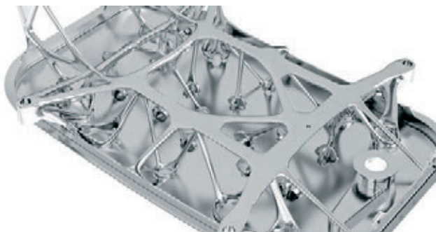
» Servisna letalska vrata dimenzij 775 x 477 x 238 mm z optimizirano geometrijo izdelana z litjem ob uporabi forme natisnjene s 3D-tiskalnikom. (Vir: Voxelfjet)
