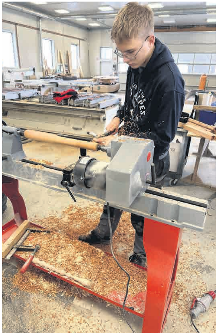
Izdelovanje žvegla na stružnici
