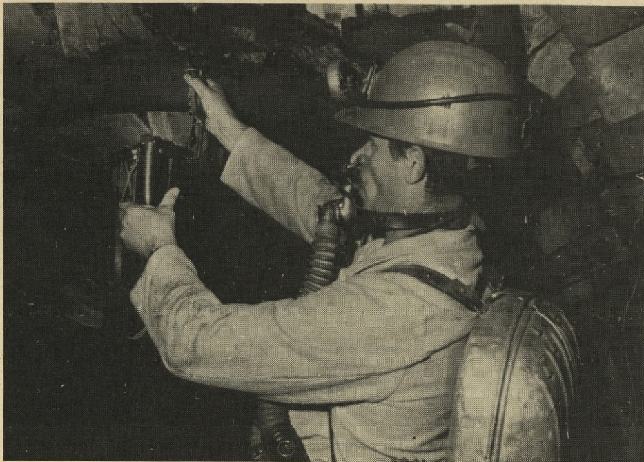
Rudnik Trbovlje, reševalna vaja. Kontrola metana z interferometrom S1 10.
