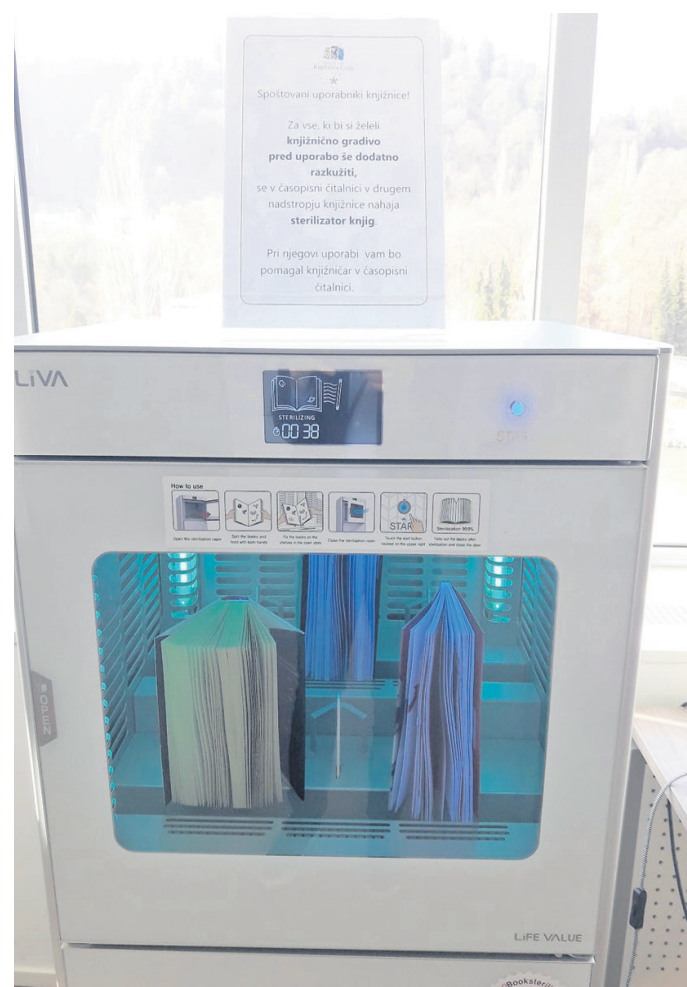
Sterilizator knjižničnega gradiva, nova tehnologija iz Južne Koreje. (Foto: OKC)
