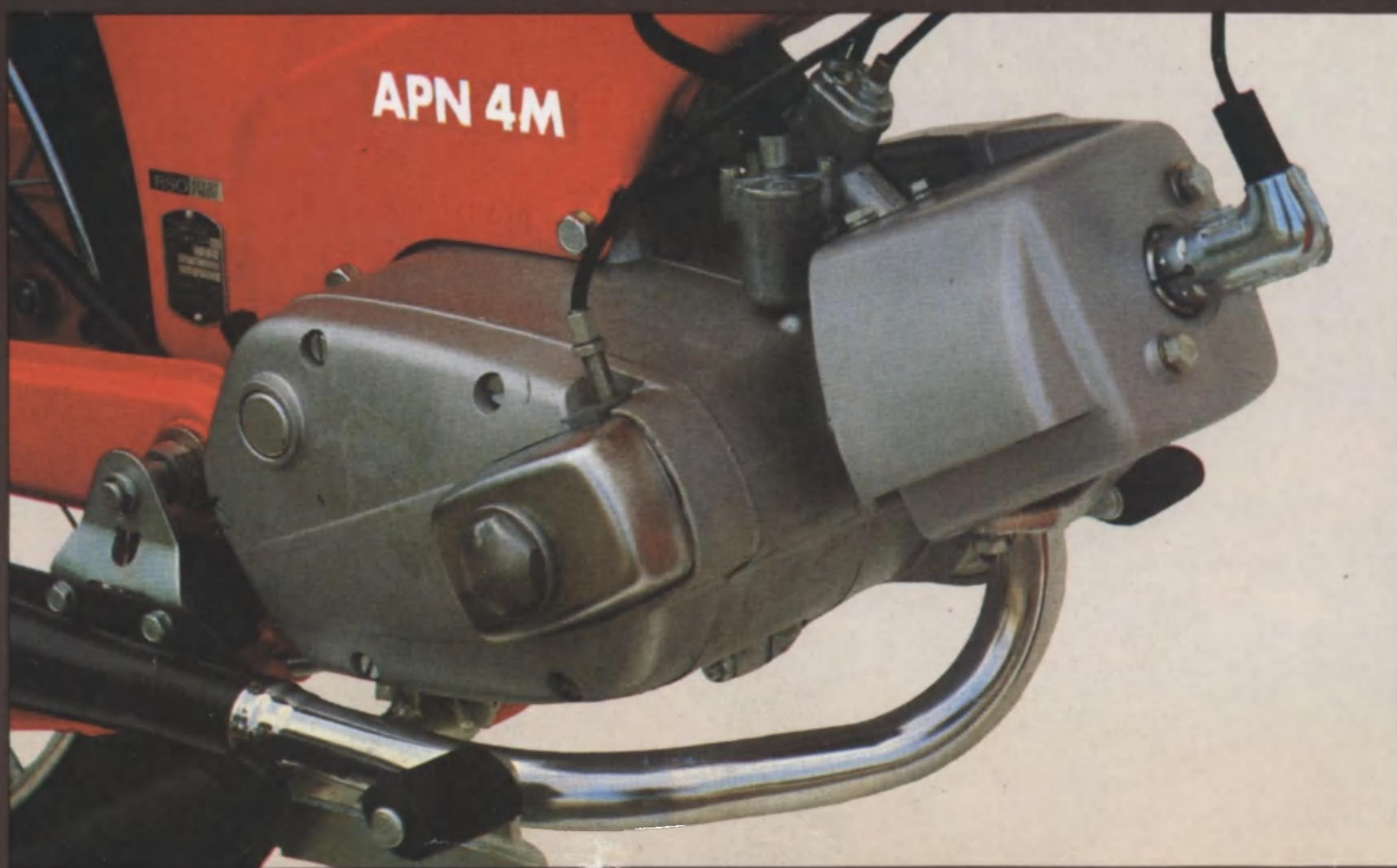
TOMOS APN 4 M je motorni točak sa okvirom od presovanog čeličnog lima. Sve varijante opremljene su motorom sa četiri stepena prenosa. Svi tipovi motornih točkova APN imaju vrlo jaku konstrukciju te su izvanredno podesni za bezbednu vožnju po svakojakim terenima. Tipove ovih motora može voziti svako, koji ima vozačku dozvolu bilo koje kategorije. Ako takve dozvole nema, dovoljna je za vožnju potvrda o savladanju saobraćajnih propisa.
