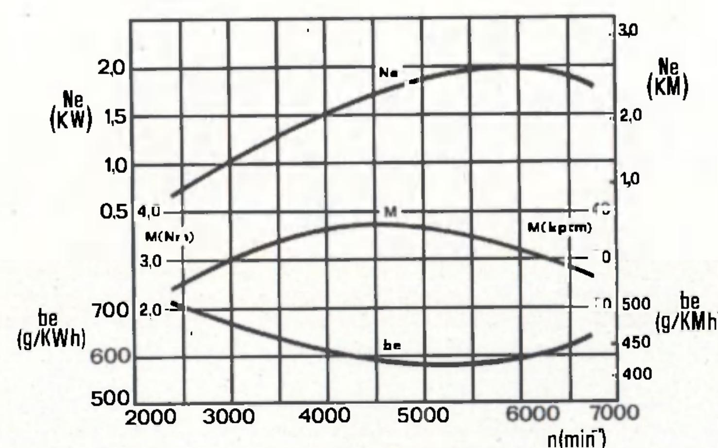
Dijagram trajne snage motora, max. momenta i specifične potrošnje goriva po JUS M. F. 2.025, važi za osnovnu varijantu motora TOMOS UMO 06 00.
