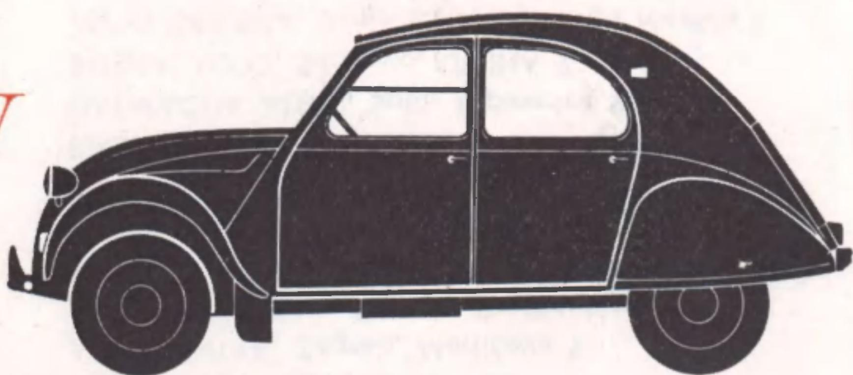
**KAMIONET TOMOS-CITROEN 2 CV AZU** — dvocilindarski motor, 66 × 62 mm, 425 ccm, efektivna snaga 16 KS, vazdušno hlađen, četiri sinhronizovane brzine i jedna za vožnju unazad, maksimalna brzina 95 km/h, potrošnja goriva 6 l na 100 km, nosivost 250 kg i dve osobe.
