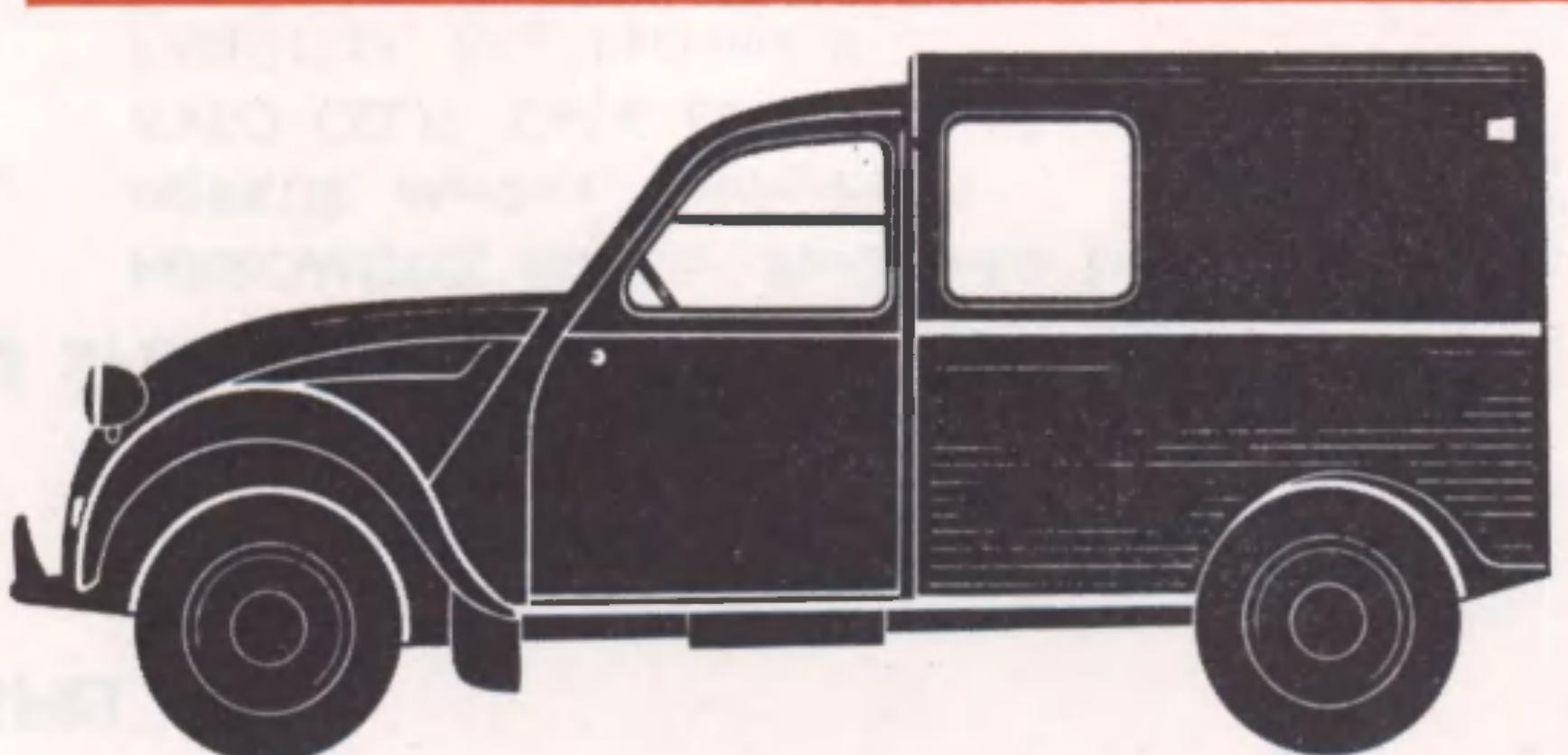
**PUTNIČKI AUTOMOBIL TOMOS-CITROEN 3 CV AMI-6** — dvocilindarski motor, 74 × 70 mm, 602 ccm, efektivna snaga 25,5 KS, vazdušno hlađen, četiri sinhronizovane brzine i jedna za vožnju unazad, maksimalna brzina 112 km/h, potrošnja goriva 6,3 l na 100 km.
