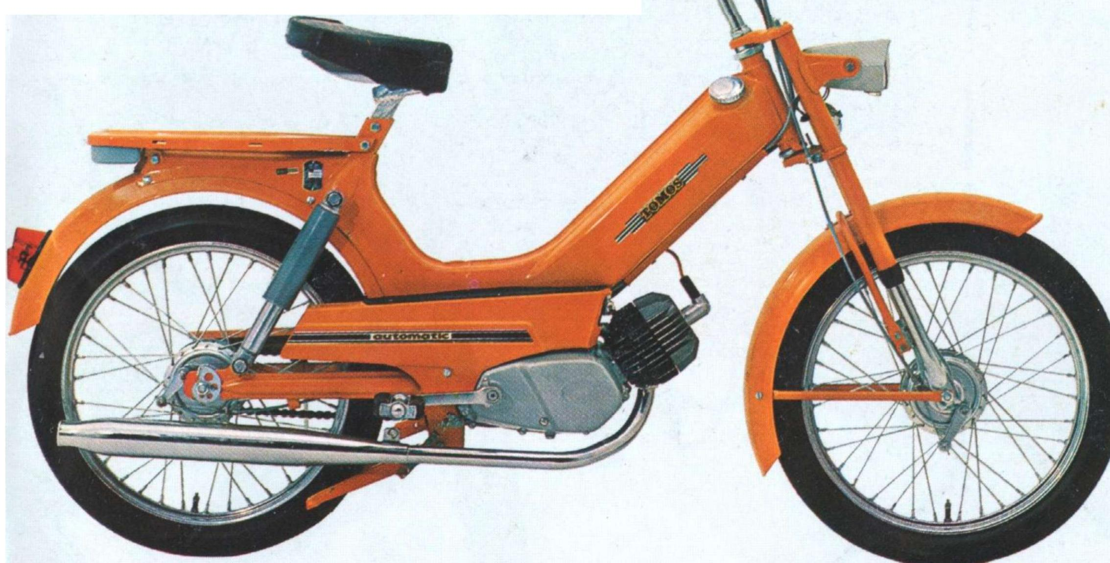
**TOMOS AUTOMATIC 3 K** opremljen je nožnim pokretačem (toidk-sitanjem) sa odopiračima za noge, oozriom polugom za zadnju koćnicu i dlektromonom sirenom.
