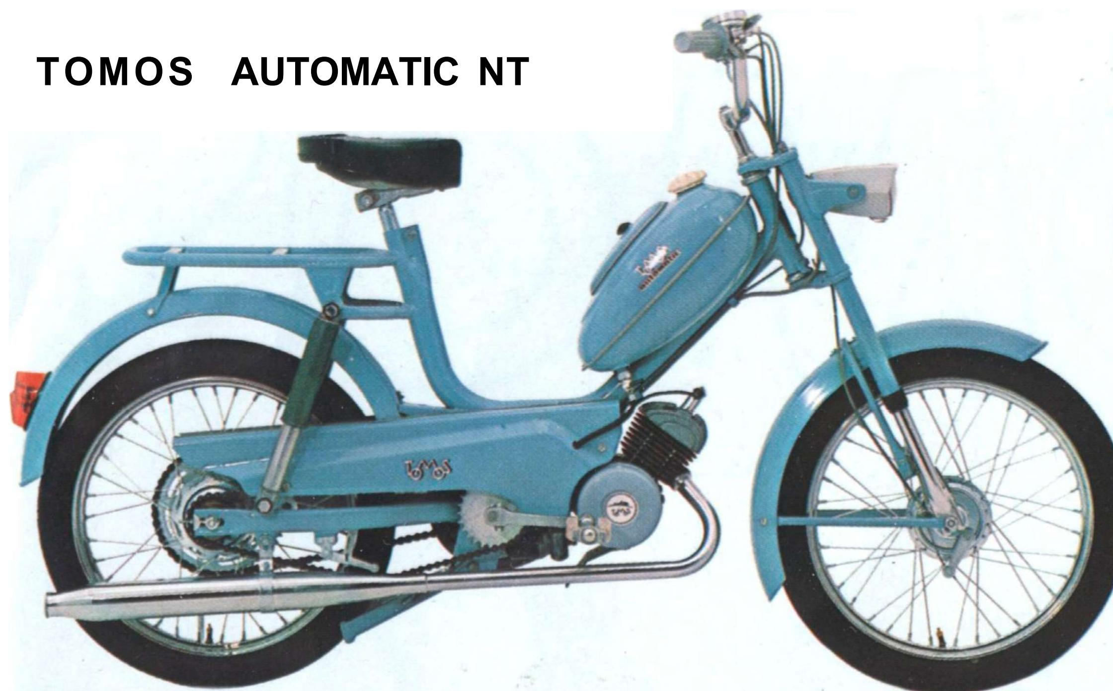
**TOMOS AUTOMATIC 3** sa jednocijlindarskim, dvotaktnim motorom. Hlađenje direktnom vazdušnom strujom. Prečnik cilindra 38 mm, hod klipa 43 mm, radna zapremina 49 ccm, stepen kompresije 8,5 : 1, maksimalna snaga motora 2 KS kod 5500 obrt./min, maksimalna brzina 45 km/h, savlađivanje uspona 20 % kod opterećenja sa 80 kg. Dvobrzinski automatski menjac sa dva centrifugalna kvačila. Normalna potrošnja goriva 2 l na 100 km.
