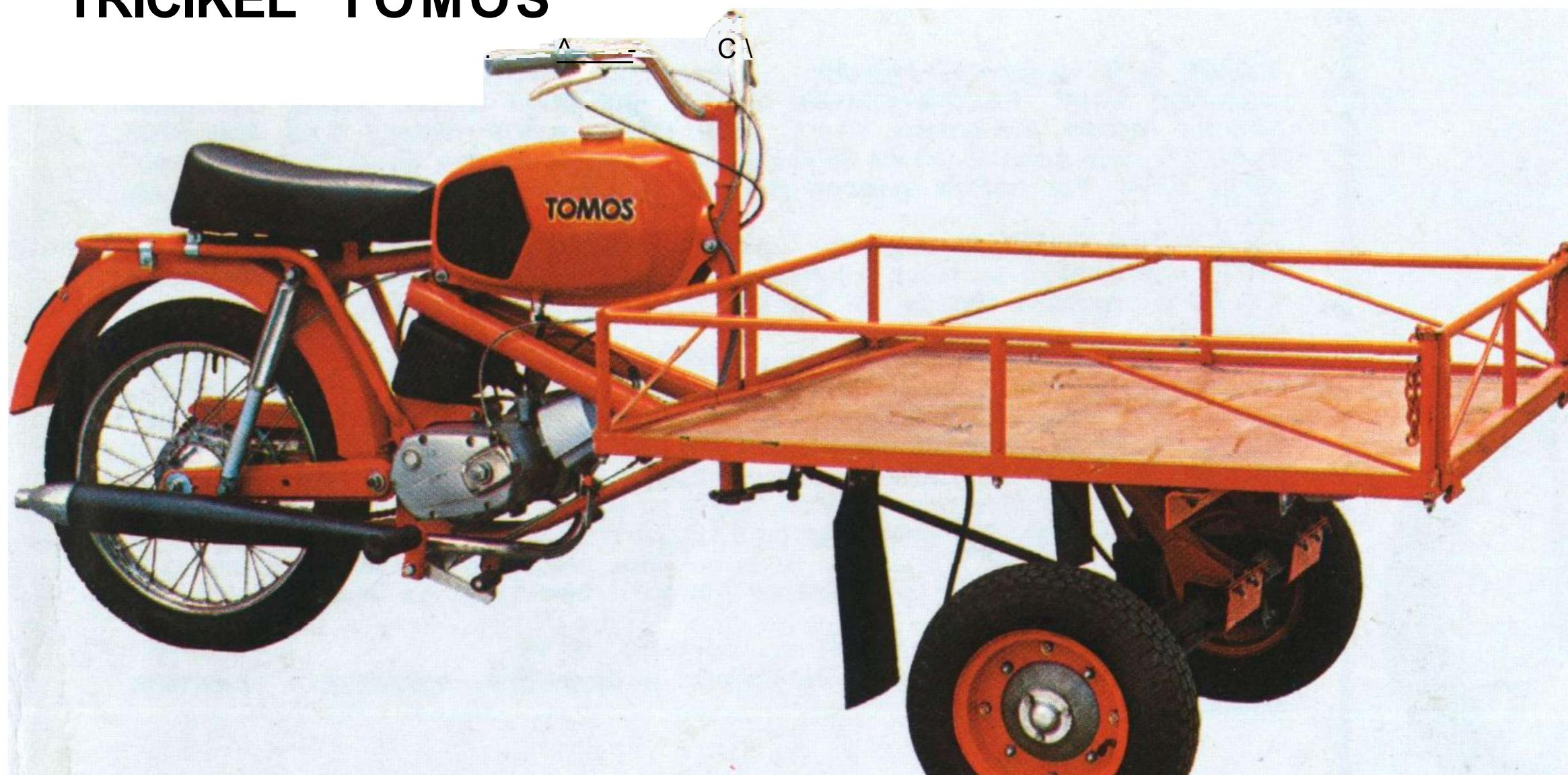
**TRICIKEL TOMOS** opremljen je sa jednocilinadarskim, dvotaktnim motorom sa prinudnim vazdušnim hlađenjem ventilatorom. Prečnik cilindra 38 mm, hod klipa 43 mm, radna zapremina 49 ccm, stepen kompresije 8:1, maksimalna snaga motora 2,4 KS kod 5000 obrt./min, maksimalna brzina 40 km/h, savlađivanje uspona do 32 % kod propisanog opterećenja, četiri nožne brzine. Normalna potrošnja goriva 2,5 l na 100 km.
