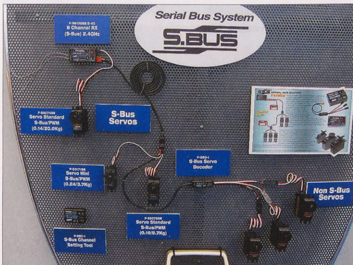
V izogib preveliki količini servokablov v večjih modelih so pri Futabi predstavili sistem S-bus.
