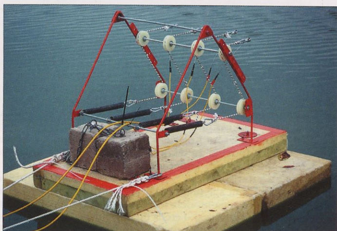
Slika 11. Prikaz pritrditve antenske zanke ob pomolu na SP na Madžarskem
