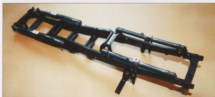
Slika 13. Na vrhu listnatih vzmeti so koščki polistirena, ki podvozje dvignejo na pravo višino.
