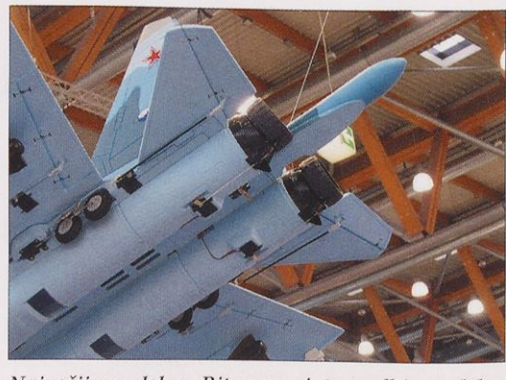
Največji model v Ripmaxovi ponudbi modelov freewing je dvomotorni Su-31 s kar 11 servomehanizmi za krmiljenje krilc, uvlačljivega podvozja in vektorskega potiska.
