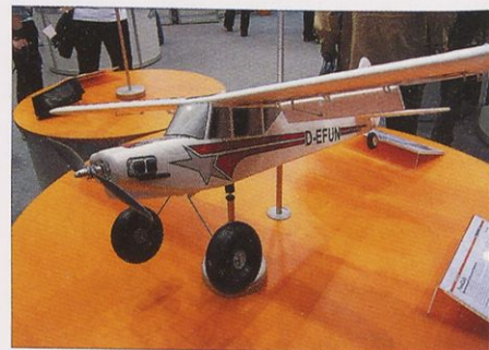
Glavna značilnost Multiplexovega modela funcub so velika kolesa in zakrilca, ki omogočajo izredno nizke hitrosti letenja.
