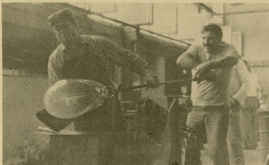
Iz steklene taline potem predoblikujemo skledo...
