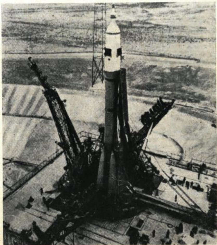
Sojuz na sovjetskem raketnem strelišču. Z belim pokrovom prekriti valj na vrhu rakete skriva vsemirsko kabino Sojuz. Raketa sama je siva. Močno železno ogrodje, ki se je dotika na desni, je raketni podstavek. Na tem podstavku pritrjeno pripeljejo raketo v vodoravni legi na strelišče. Tam jo začne podstavek počasi hidravlično dvigati, dokler ne stoji pokonci. Veliki spuščeni ročici spredaj in zadaj sta montažna stolpa, ki se lahko dvigneta in raketo takorekoč objameta. Ne preveč nagnjeni stolp na levi je oskrbovalni stolp, s katerim ostane raketa povezana do odleta. Višina rakete same znaša 40 m. Slika je bila objavljena v sovjetski reviji s podpisom: Vsemirska ladja Sojuz.
