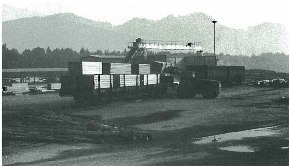
Na sliki, ki je bila posneta na CMS Limbuš, se vidi nakladanje tesanega lesa iglavcev na vagon serije R. V ozadju sta še prazna visokostenska vagona serije Ea, ki čakata na tovor sekancev ali celuloznega lesa iglavcev
