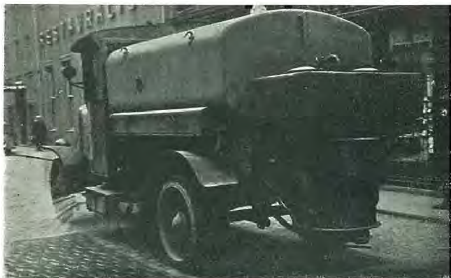
Škropilni avtomobil mariborske občine s plinovim generatorjem na končniku. (Foto: Mirko Japelj)
