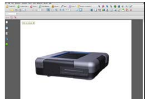
4 | Sestav iz Catie je tako uvožen. S klikom leve miške tipke (LMT) je potrebno le še aktivirati opcijo 3D v levem zgornjem kotu in predmet lahko prično vrteti, povečevati, premikati ...
