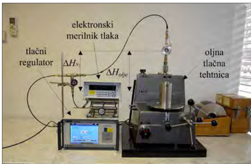
Slika 2. Merilni sistem za primerjavo hidravličnega in pnevmatskega merilnega sistema za tlak v LMPS
