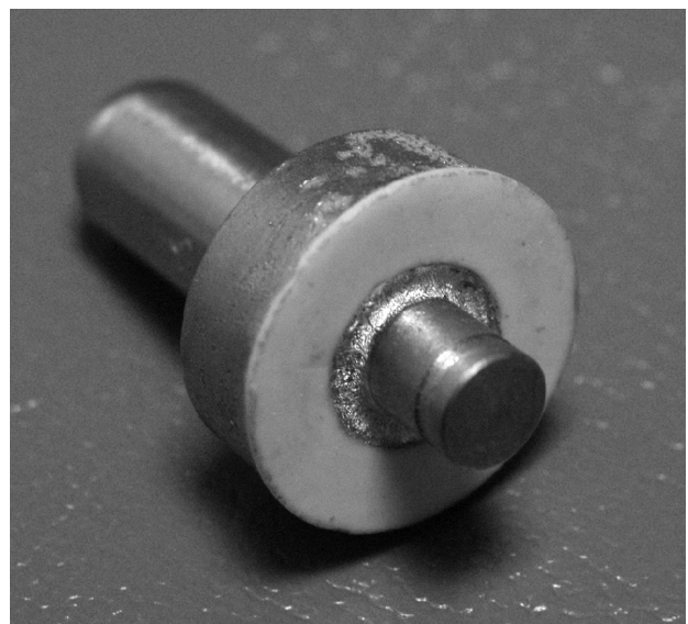
Slika 6: Molibdenska elektroda ( D = 6 mm), spajkana z bakrom v keramični izolator plinskega prenapetostnega odvodnika
