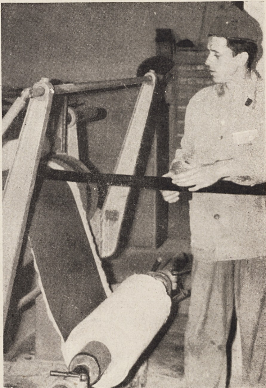
Pri vlečenju plošče za dubliranje corda je treba paziti na dimenzijo
