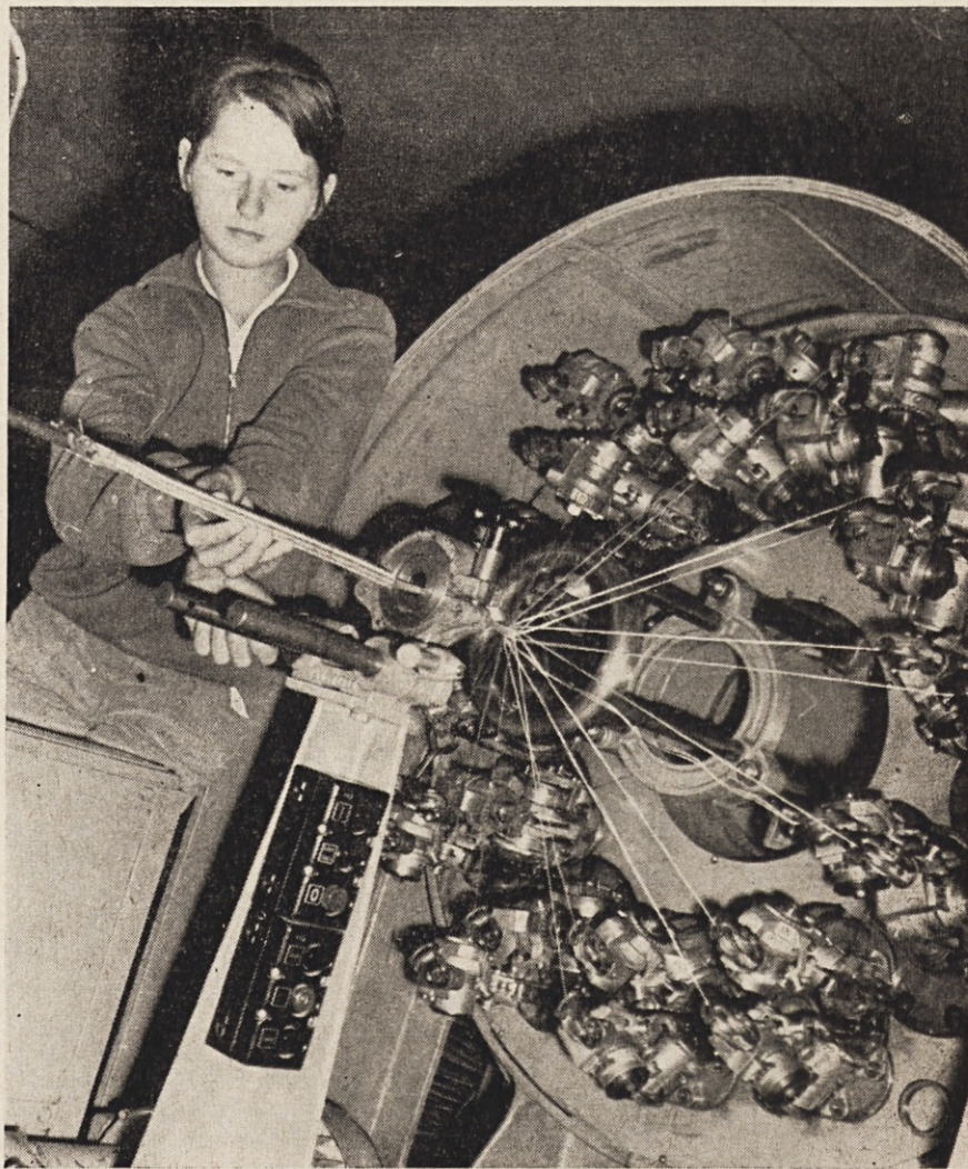
Nov pletilni stroj za pletenje žice visokotlačnih cevi terja vso pozornost in natančnost
