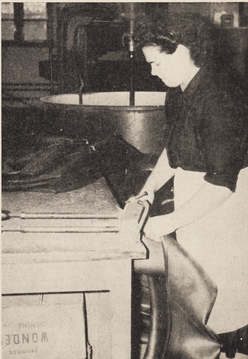
Pri preizkušanju avtrozračnic mora delavka temeljito pregledati ne le ventil, marveč celotno zračnico
