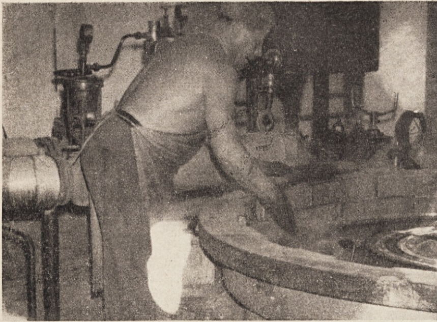
Pri vulkanizaciji avtoplaščev v avtoclawu je delavec v nenehni nevarnosti, da ga opeče para, ki prihaja iz ogrevne cevi
