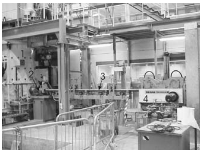
Slika 12: Industrijska naprava za kontinuirno litje (1 – livna peč, 2 – hladilnik s kokilo, 3 – uliti drog, 4 – vlečna naprava)
