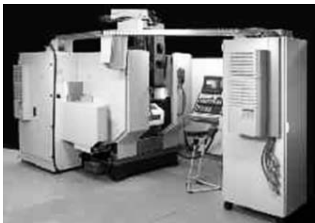
Slika 8: Naprava za 3D-lasersko poliranje (13)
