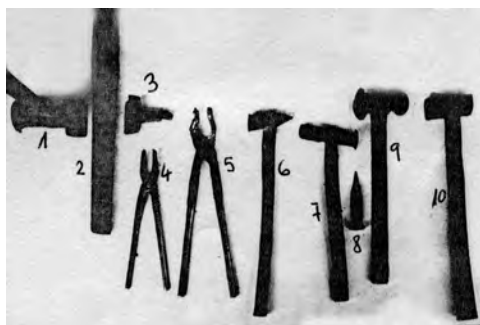
170. 1 rundhamer, 2 del osi, 3 rundštekelj, 4 kombinirke, 5 klešče za ogenj, 6 pajser, 7 folchamer, 8 sprebijač, 9 okroglo kladivo, 10 štolhamer.
