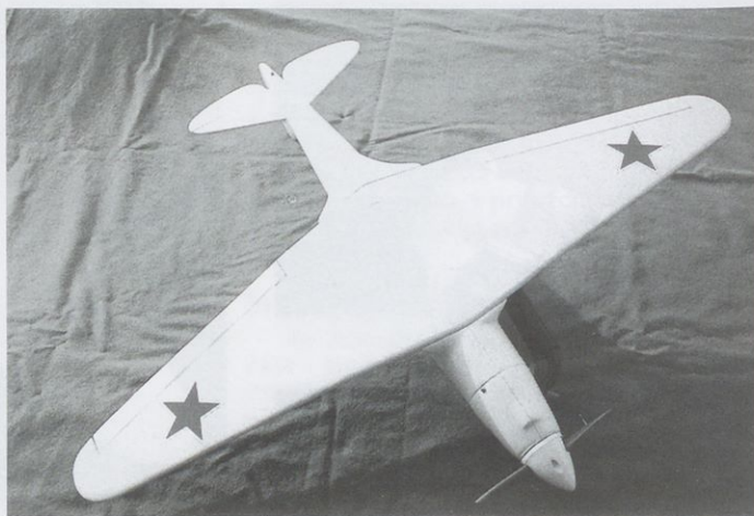
Krilo je spredaj pritrjeno na trup z bukovim zatičem \varnothing 5 mm, zadaj pa je privijačeno s plastičnim vijakom M 4.
