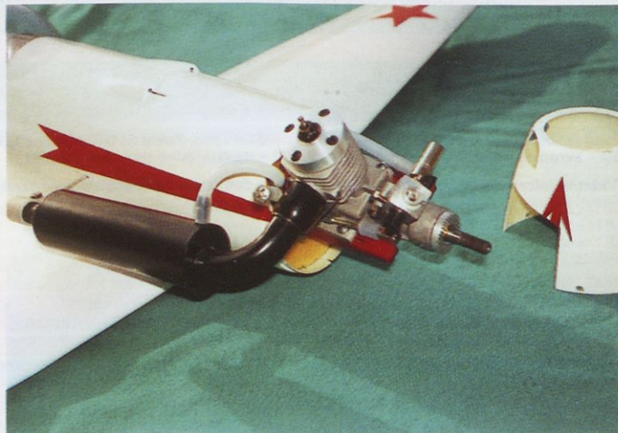
Pokrov motorja je na trup pritrjen s tremi samoreznimi vijaki.
