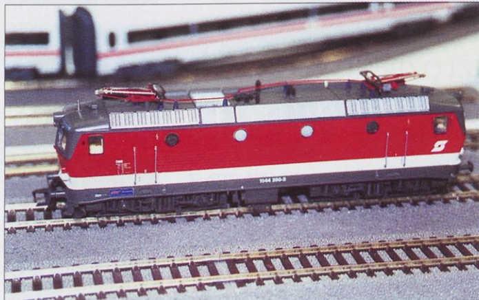
Rocov model avstrijske električne lokomotive 1044, ki je po novem prilagojena za sistem AC z digitalnim vodenjem. Taki vlaki vozijo tudi na Jesenice.
