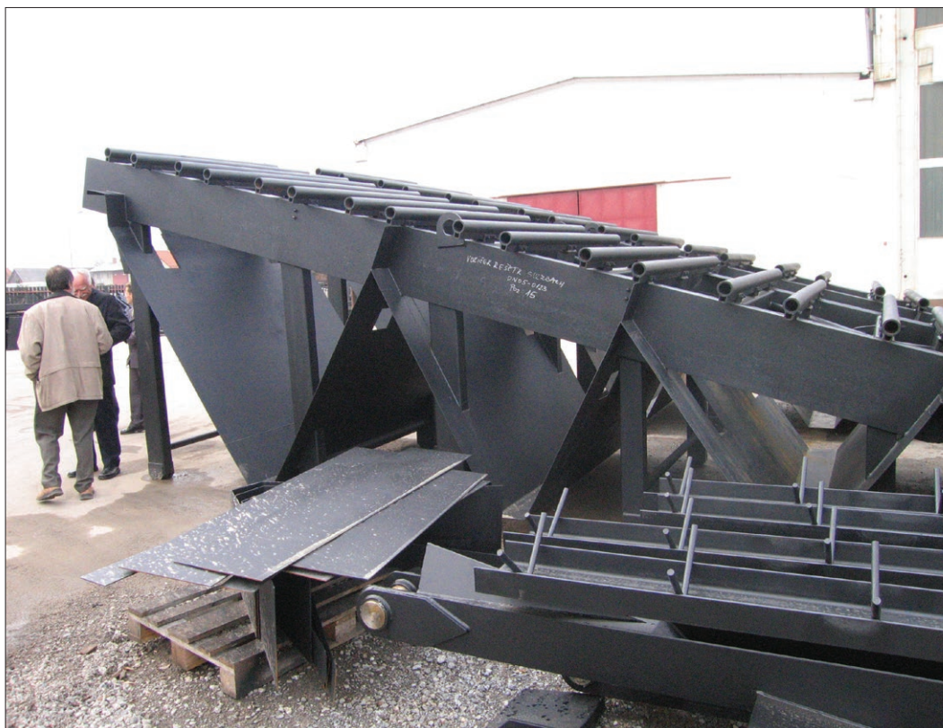
Slika 2: Rešetka kotla za incineracijo odsluženega lesa (foto: M. Humar)
