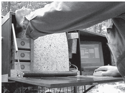
Slika 1: Merilni inštrumenti na kabini traktorja
