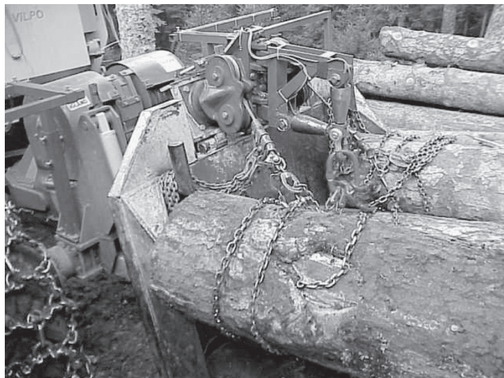
Slika 4: Woody 110 - inštrument za merjenje vlečne sile na vrvi vitla
