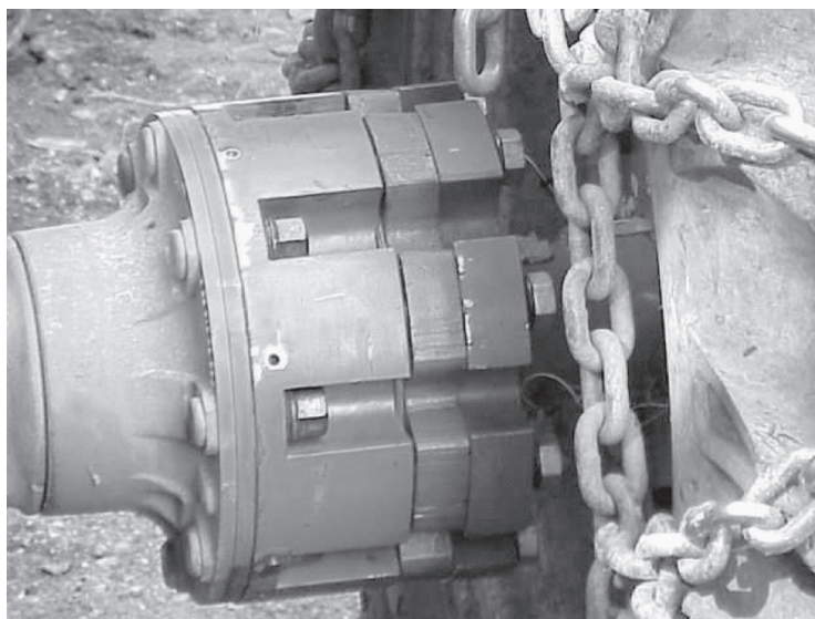
Slika 2: Woody 110 – vgrajen dinamometer na mestu med polosjo in kolesom
