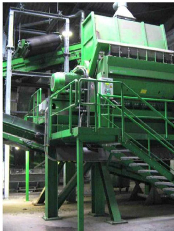
Slika: Drobilnik z dodanim magnetnim separatorjem pri pripravi TG (Breuer, 2007)
