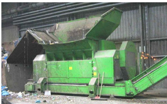
Slika: Drobilnik pri mehanski obdelavi (Breuer, 2007)
