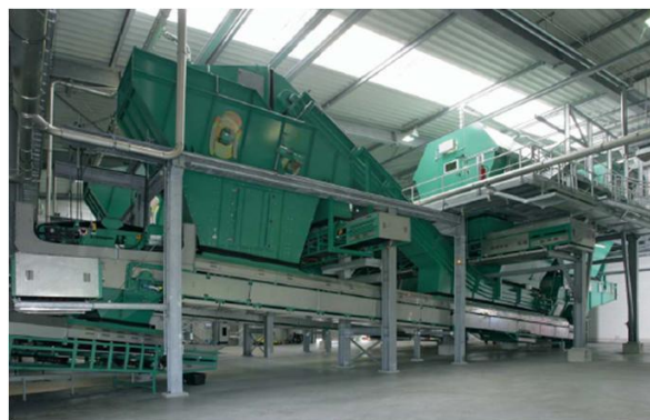
Slika: Balistični separator (levo) in bobnasto sito (desno) (Merten in sod., 2006)
