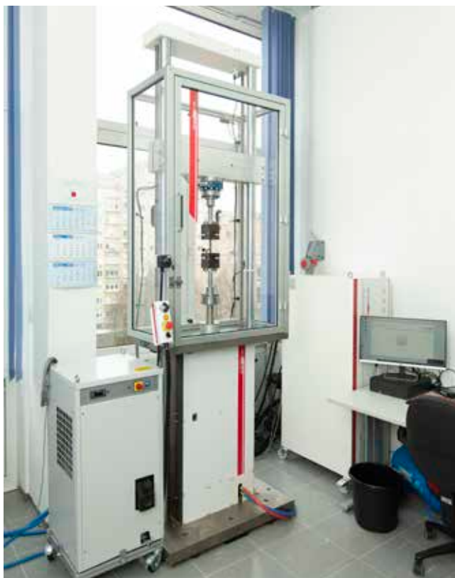
Slika 2 : Večosno statično in dinamično preizkuševališče (Foto: IFP, d. o. o.)
