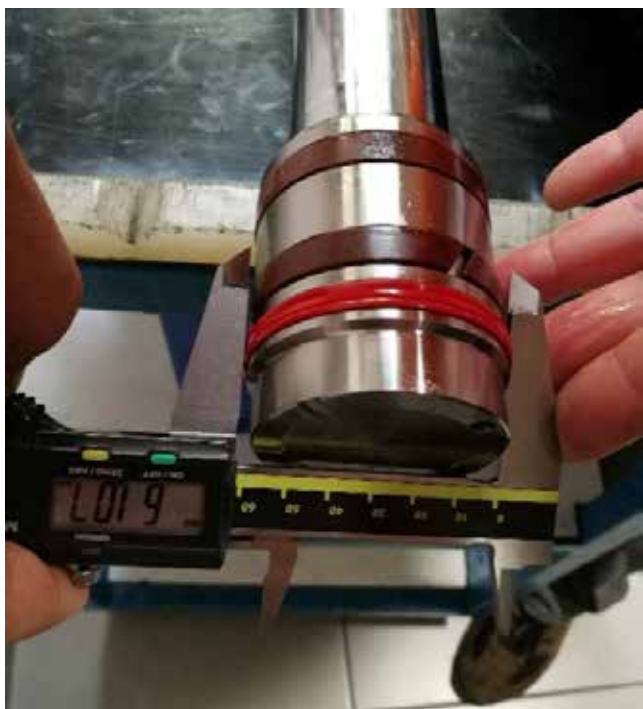
Slika 6 : Bat hidravličnega valja z dvema vodilnima obročema
