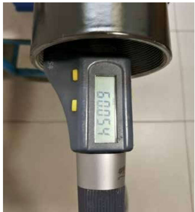
Slika 5 : Meritev notranjega premera cevi hidravličnega valja
