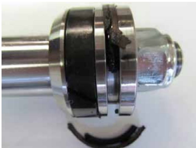
Slika 2 : Poškodovano batno tesnilo (premer bata 50 mm)
