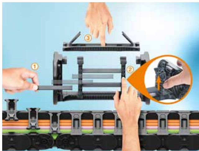
Slika 2 : Sestavljanje e-verige E4Q: polica (1), vmesna stena z zaklepi (2), enostavno odstranljiva prečka (3)
