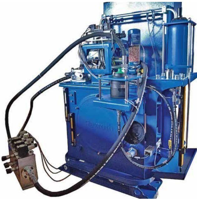
Slika 2 : Priklučitev objekta testiranja na hidravlični agregat IMP-PHA
