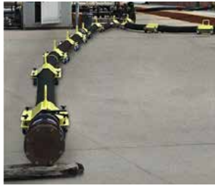
Slika 1: Podporni voziček in njegova uporaba v pristanišču
