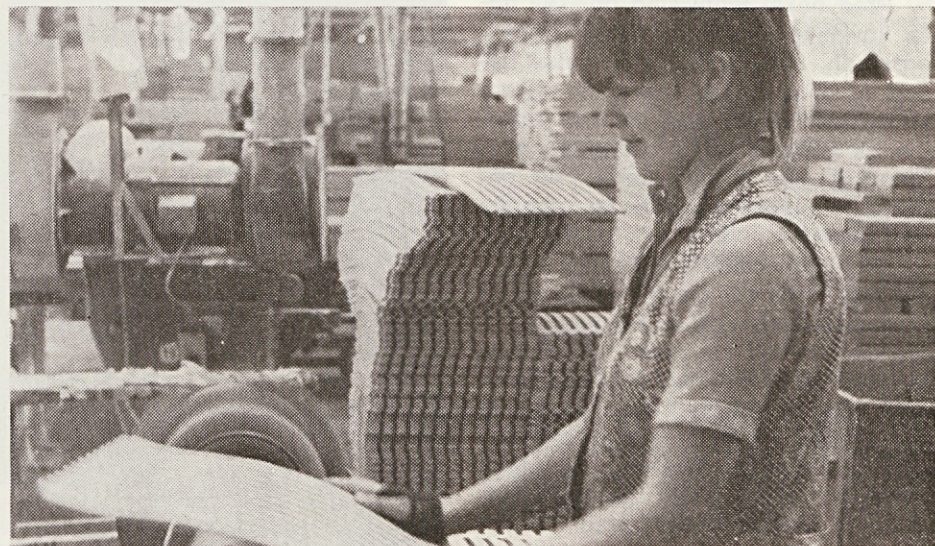
Že nasploh je najbolj zanimivo gledati, kako nastaja stol. Če pa je to po celem svetu znani Kraljev in Stolov Rex, je pozornost še večja. Tudi Kitajci kar niso mogli stran — pa ne le zaradi naše mlade sodelavke, ki je tokrat na krtačnem stroju brusila in čistila sedala in naslone rexov
