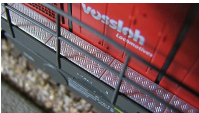
Zelo natančno izdelana rebrasta pohodna pločevina vzdolž lokomotive na obeh straneh je namenjena hoji in povezavi med kabinama.
