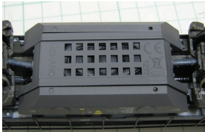
Na spodnjem delu lokomotive med obema podstavnima vozičkoma, kjer je prostor za rezervoarje, je nameščen velik podolgovat zvočnik.
