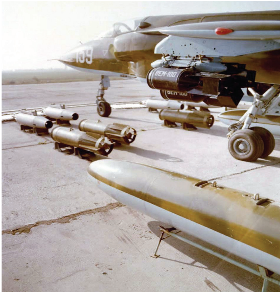
IAR-93A beli 159 s prosto padajočimi bombami, dodatnim hramom za gorivo in kasetnimi bombami vrste BEM-100
