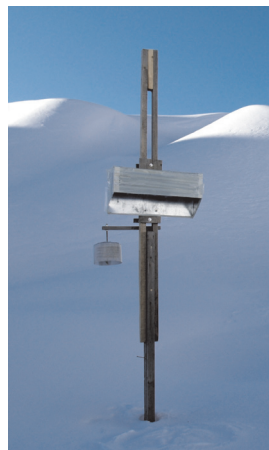
Slika 6. Temperaturna postaja z digitalnim regulatorjem (spodaj levo) in minimalnim termometrom (zgoraj desno) v mrazišču pod Krajem Kala na Lepi Komni. Foto: Gregor Vertačnik
