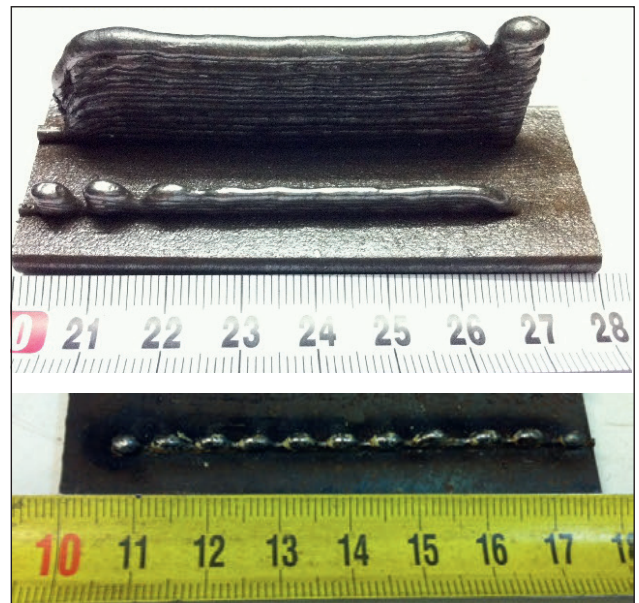
Slika 3. Varjenje pri jakosti varilnega toka 40 A in oblačni napetosti 10,3 V po postopku CMT (hitrosti varjenja od zgoraj navzdol 3, 7,5 in 12 mm/s)
