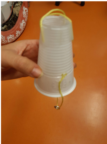
Slika 30: Prikaz zgornjega in spodnjega dela denzometra
