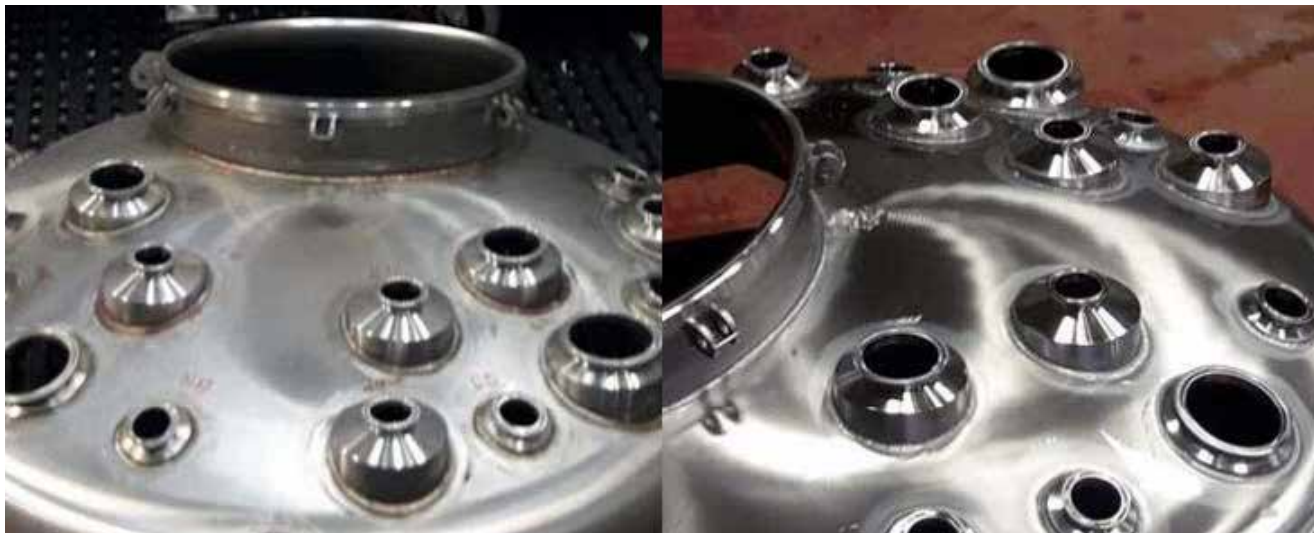
Brinox d. o. o., prej: procesna posoda pred kemično obdelavo, potem: procesna posoda po kemični pasivaciji
