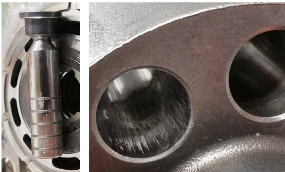
Slika 3 : Primer prekomerne obrabe aksialne batne črpalke hidrostatičnega pogona:
