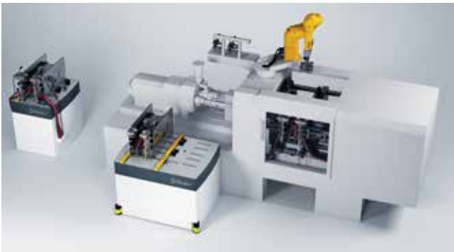
Slika 1: Robotizirana menjava orodij
