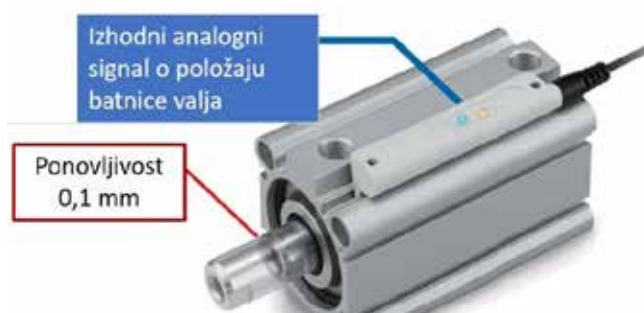
Slika 4 : Uporaba senzora D-MP pri pnevmatičnem valju
