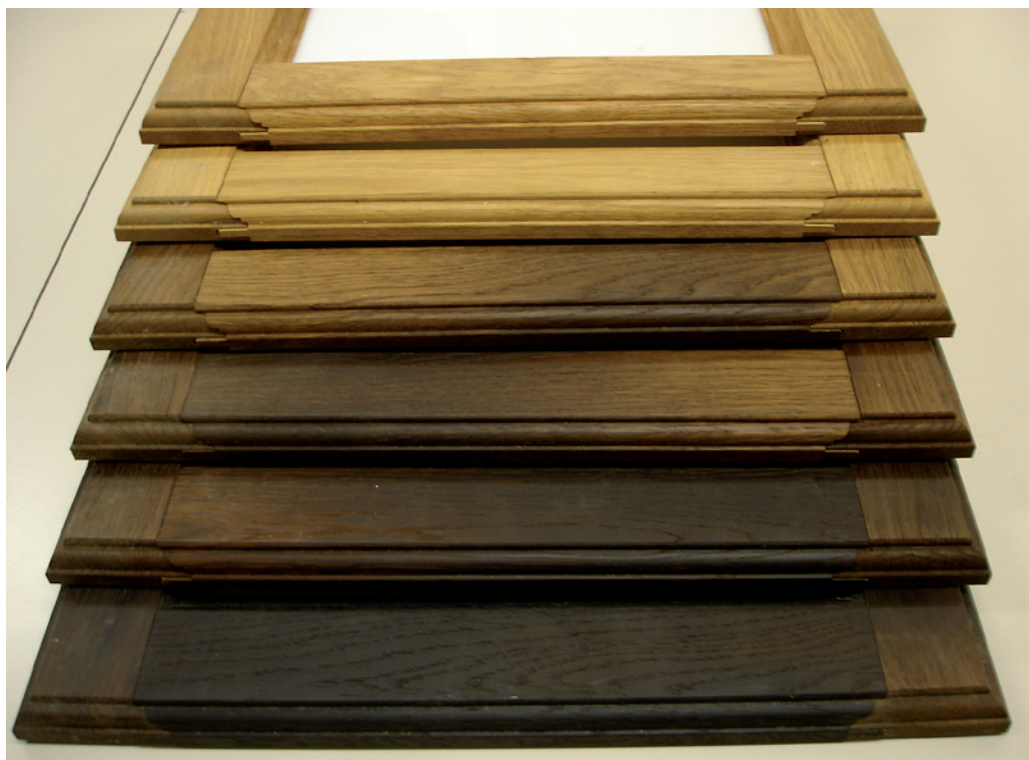
Deformacija modificiranih in nemodificiranih front kuhinjskih omaric po 6 tedenskem namakanju (foto: F. Pohleven)
