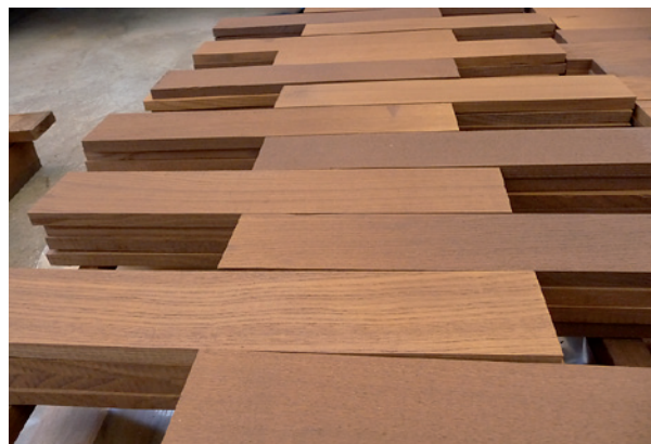
Slika 3: Termično modificirane deščice (foto: M. Humar)
