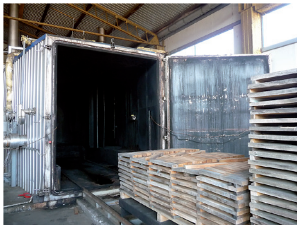
Slika 2: Odprta komora za termično modifikacijo lesa (foto: M. Humar)
