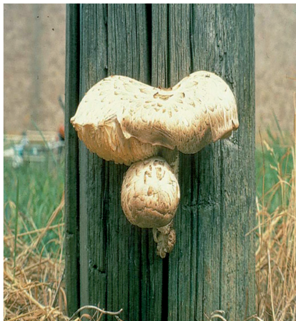
Značilna plodišča luskaste nazobčanke, ki izraščajo iz telekomunikacijskega droga, impregniranega s kreozotnim oljem (foto: dr. D. Dickinson)
