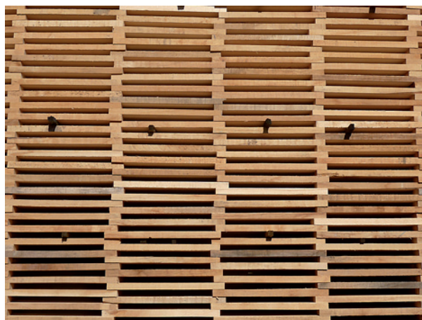
Slika 1: Zložaji, pripravljeni za termično modifikacijo (foto: M. Humar)
