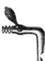
Pod. 70. Cevna pipa za drobnejše gumijeve cevi (za pretakanje iz večjih sodov v manjše).
