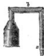
Podoba 78. Žveplalna svetilka (za žveplanje vina v nepolnih sodih od vrha).
