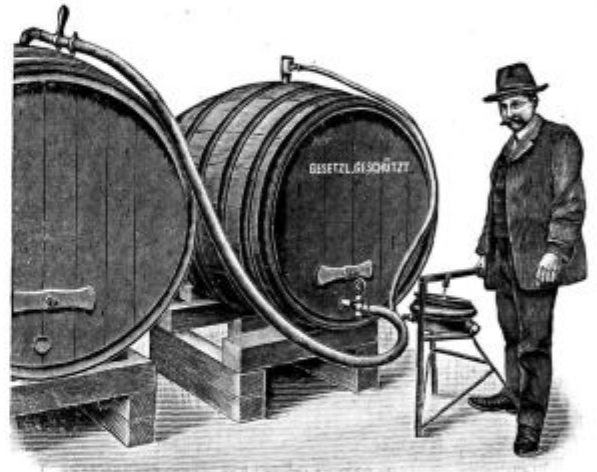
Podoba 64. Meh za pretakanje finih, zlasti buketnih (dišečih) vin.
