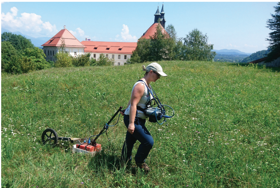
Meritve z georadarjem GSSI SIR3000. (foto: Branko Mušič)
