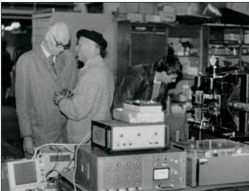
Prof. Kralj in prof. Prosenc v Lendavi, med izvedbo preizkusov na novi napravi za varjenje z magnetno krmiljenim oblokom, ki je bila razvita v Varstroju, v Lendavi
