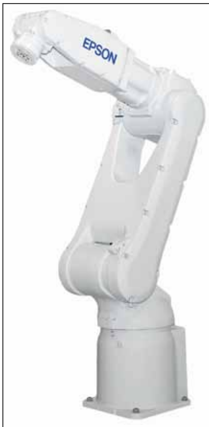
Slika 1. Epson S5L – doseg 950 mm, nosilnost do 5kg
