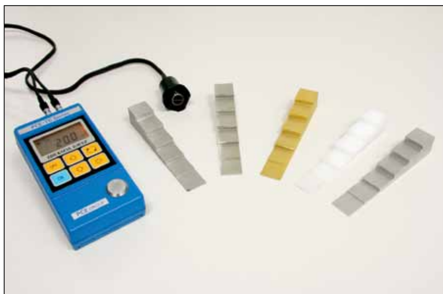
Slika 3. Kalibracija merilnika debeline na etaloni iz različnih materialov in različnih debelin
