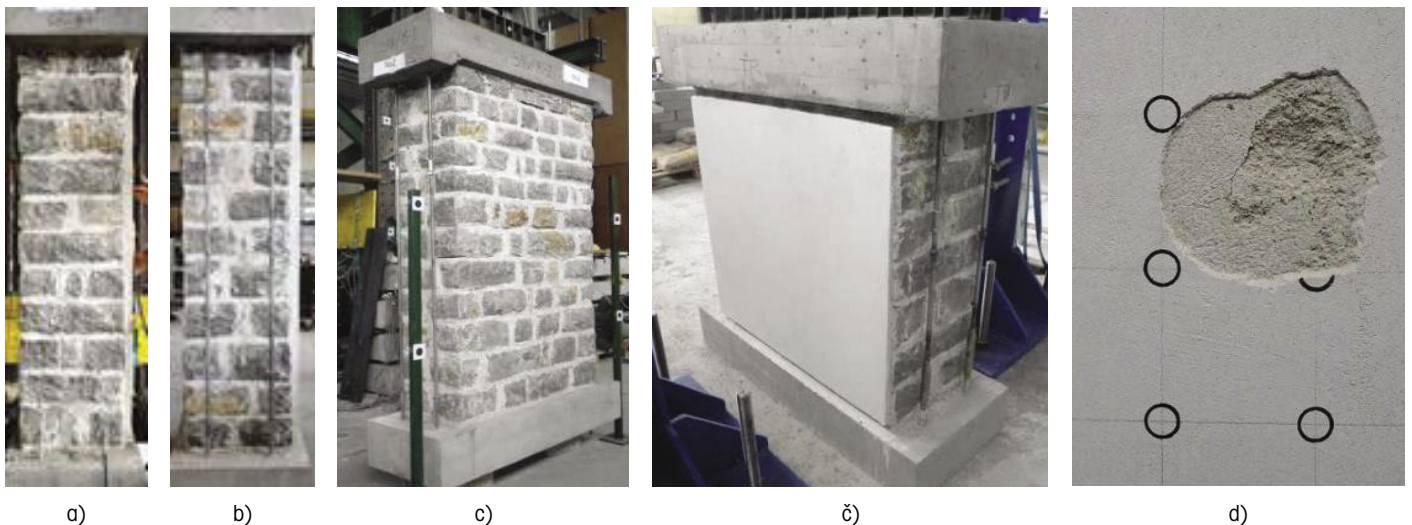
Slika 6 • Morfologija a) povezanega zidu in b) nepovezanega zidu, c) zid za preizkušanje, č) zidek z ometom ter d) omet z vidnim grobim in finim slojem
