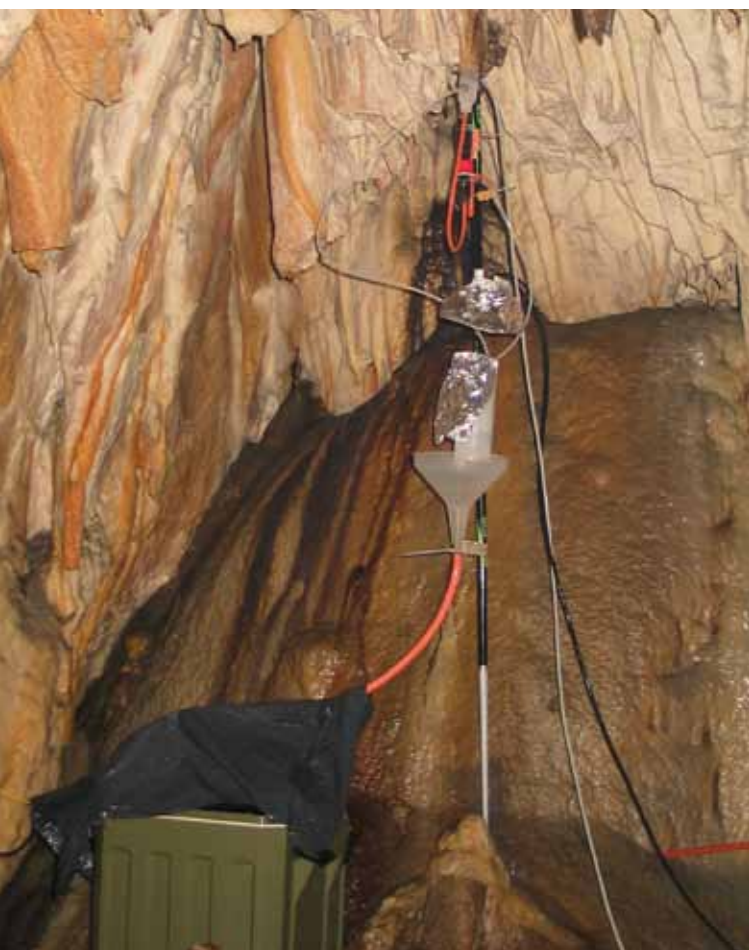
3 Fizikalne meritve in avtomatski zajem vzorcev stalnega curka J v Postojnski jami. Physical measurements and automatic sampling of the permanent trickle J in the Postojna cave.
