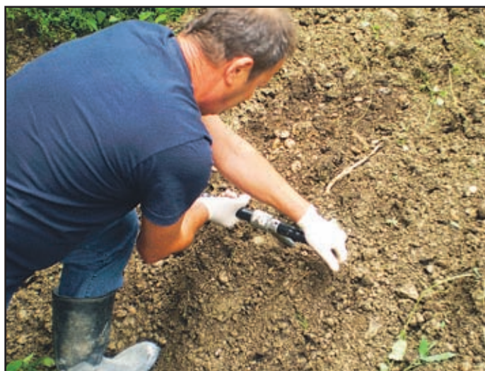
Raziskovalci ERICa so za vzorčenje tal izbrali štiri mesta, ki so bila v poplavah najbolj prizadeta. Vzorce so jemali do 20 centimetrov globoko.
