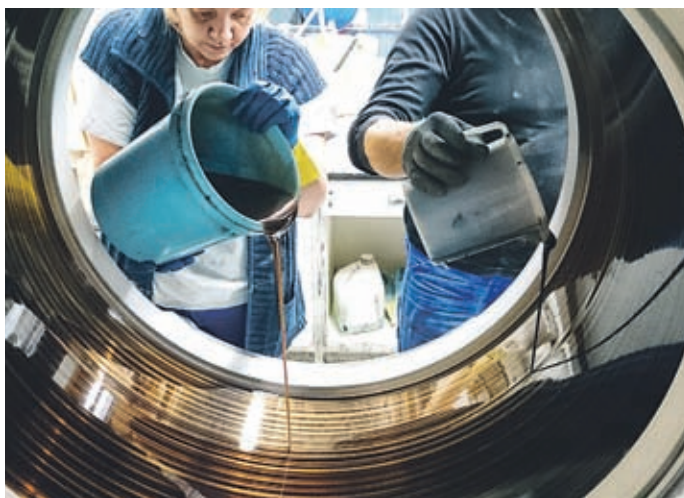
Strojem navkljub približno polovico dela pri proizvodnji gumbov še vedno opravijo ročno. Pripravijo mešanico za poliestrsko maso, vstavljajo gumbe v stroj za lasersko graviranje, jih površinsko barvajo, pregledujejo, preštevajo in pakirajo. Strojno pa iz pasu poliestra izsekajo žetone, jih izstružijo, naluknjajo in spolirajo.
